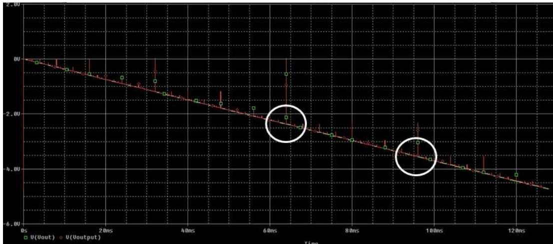
Σχήμα 4.18 Απόκριση του κυκλώματος μετά από την τοπική διόρθωση των αντιστάσεων R_{10} και R_{19} (δηλαδή διόρθωση με τη χρήση της δεύτερης τεχνικής).
