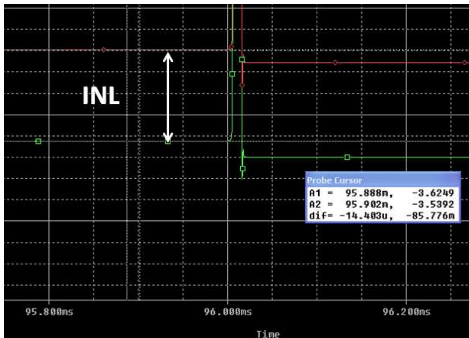
Σχήμα 4.14 Στιγμιότυπο INL σφάλματος.
