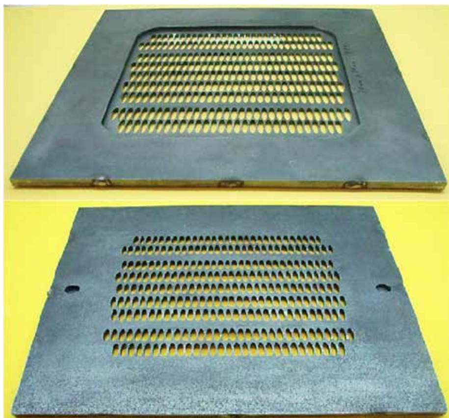
Εικόνα 5.10 Μεταλλική βάση 2 επιπέδων για την κατασκευή ημιδιαφανών ηλιακών κυττάρων 3 busbar επιφάνειας 156 \times 156 \text{ mm}^2
