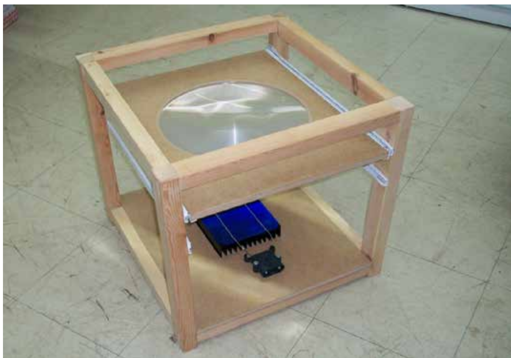
Εικόνα 3.14 Σύστημα μετρήσεων με συγκέντρωση ηλιακής ακτινοβολίας
