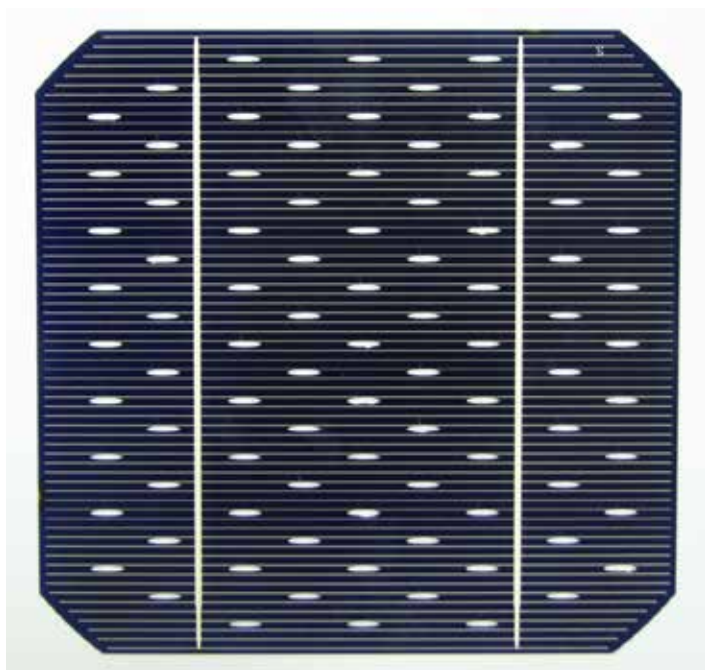
Εικόνα 5.16 Εμπρόσθια και πίσω όψη ημιδιαφανούς ηλιακού κυττάρου επιφάνειας 156 \times 156 \text{mm}^2 με 91 ελλείψεις. Οι ελλείψεις έχουν μικρό και μεγάλο άξονα 1.8mm και 8.6mm αντίστοιχα.
