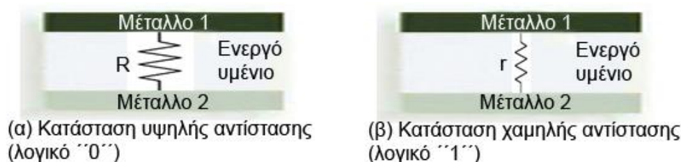
Σχήμα 4. Αρχή λειτουργίας της μνήμης μεταβολής της αντίστασης (resistive memory).
