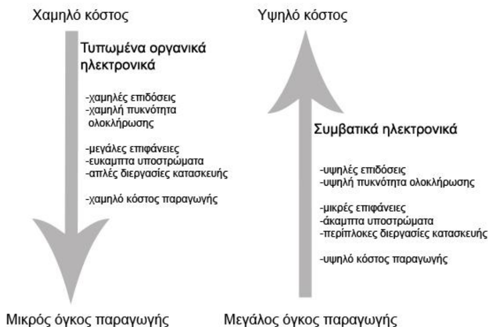
Σχήμα 5. Συγκριτικό διάγραμμα κόστους / όγκου παραγωγής ανάμεσα στην τεχνολογία των οργανικών και των κλασικών ηλεκτρονικών του πυριτίου 8 .
