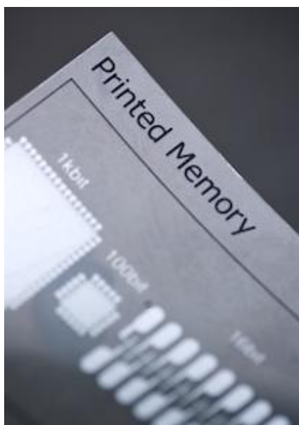
Σχήμα 4. Οργανική διάταξη μνήμης χωρητικότητας έως και 36-bits από την εταιρία Thin Film Electronics. Η μνήμη αυτή κατασκευάζεται εξ ολοκλήρου με σύγχρονες μεθόδους εκτύπωσης. (Πηγή: Εταιρία Thin Film Electronics 14 ).
