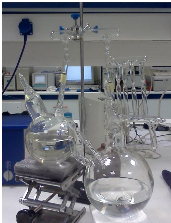
Σχήμα 7.9: Συσκευή σύζευξης για την σύνθεση των δειγμάτων τύπου A(BA')_n με n = 2, 3 A:PS και B:PI ή PDMS αλλά και του δείγματος PS-b-PDMS-b-PS' .
