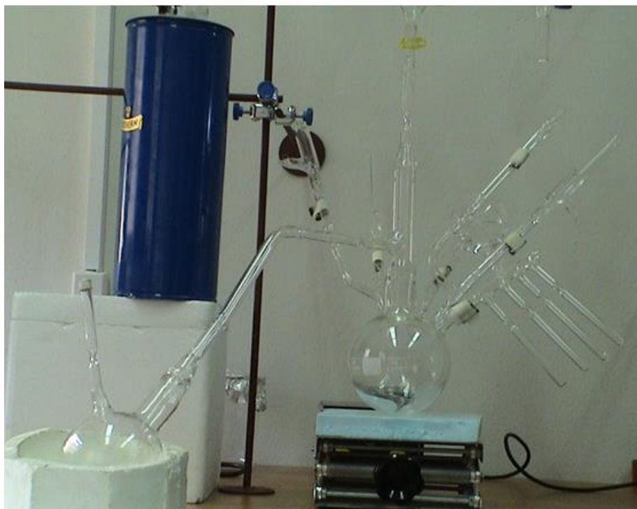
Σχήμα 7.4: Συσκευή πολυμερισμού για την σύνθεση του γραμμικού δισυσταδικού συμπολυμερούς PS^{-}b-PDMS^{(+)}Li^{(+)} .
