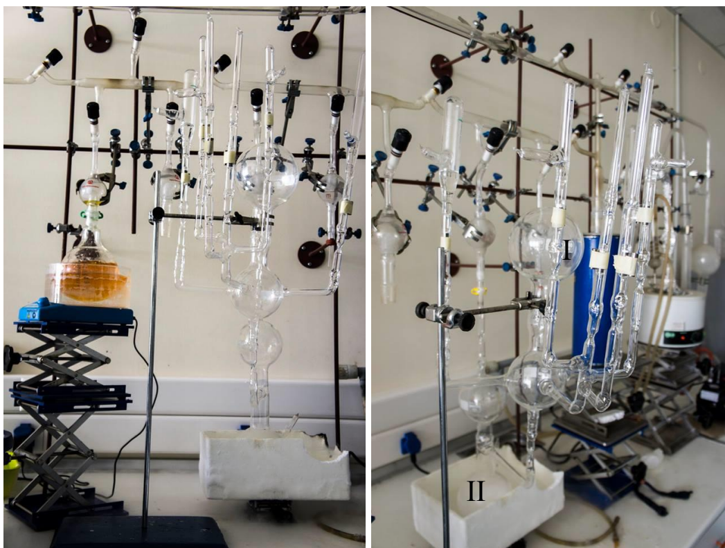
Σχήμα 7.2: Συσκευή πολυμερισμού για την σύνθεση του γραμμικού τρισυσταδικού συμπολυμερούς PS- b -PI- b -PS'.
