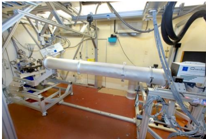
Σχήμα 8.63: Απεικόνιση δέσμης ακτίνων-X για την διεξαγωγή των πειραμάτων SAXS στο Lawrence Berkeley National Laboratory.
