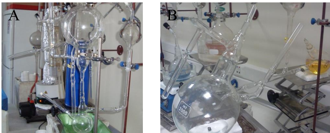
Σχήμα 7.7: Συσκευή εναλλαγής άκρων με α) το κατάλληλο σιλάνιο προσαρτημένο και β) τον ζωντανό κλάδο στυρενίου.
