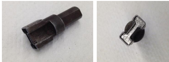
Σχήμα 8.93: Απεικόνιση καλούπιού το οποίο χρησιμοποιήθηκε (αριστερά) και το κατασκευασμένο δοκίμιο (δεξιά).
