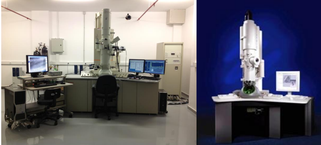
Σχήμα 8.62: Διάταξη των δύο οργανολογιών ηλεκτρονικής μικροσκοπίας διέλευσης: JEOL JEM - 2100HR (αριστερά) και FEI Tecnai G2 Sphera TEM (δεξιά).
