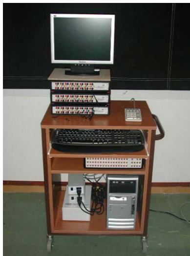
Εικόνα 7.3.5: Ψηφιακό σύστημα καταγραφής και επεξεργασίας ΗΕΓ της gtec
