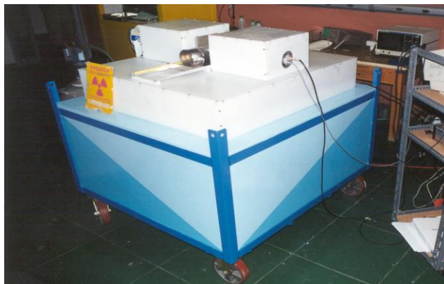
Εικόνα 3-1 Πειραματική διάταξη για άμεση ανάλυση με νετρονική ενεργοποίηση στο Εργαστήριο του Αντιδραστήρα, του Ε.Κ.Ε.Φ.Ε. «Δημόκριτος».
