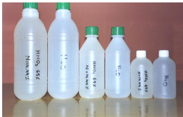
Εικόνα 3-5 Ομοιώματα αποτελούμενα από υδατικό διάλυμα νιτρικού οξέος σε πλαστικά μπουκάλια, για τη μελέτη σχεδιασμού της διάταξης PGNAA.
