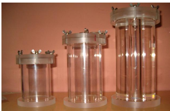
Εικόνα 3-6 Ομοιώματα πλεξιγκλάς για τη μελέτη αξονικών ανομοιογενειών στο δείγμα
