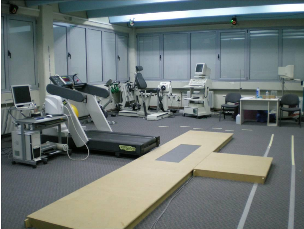
Εικόνα 42: Το δκάμερο οπτοηλεκτρονικό σύστημα ανάλυσης βάρδισης με τις κάμερες τοποθετημένες κυκλοτερώς στην οροφή. Τα δυναμοδάπεδα είναι τοποθετημένα στο κέντρο του διαδρόμου.
