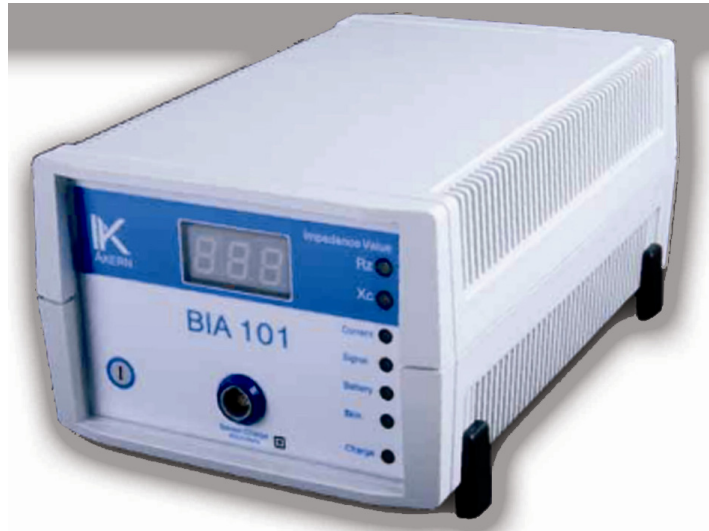
Σχήμα 12. Η συσκευή Bodygram Akern BIA 101
