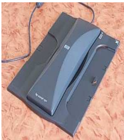
Εικόνα 4.2: Η πρόσθετη φωτεινή πηγή-TMA του σαρωτή εγγράφων hp scanjet 4570c.
