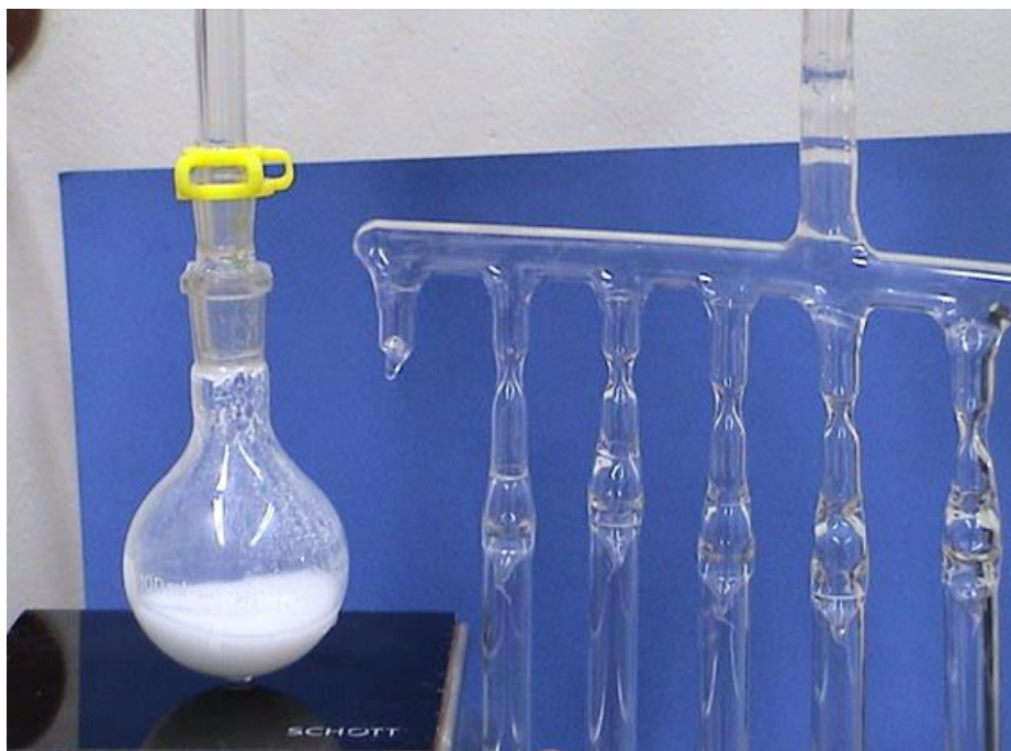
Εικόνα 4.5. Φωτογραφία αμπουλοσυσσκευής για απόσταξη μεθανόλης (δεξιά). Αριστερά παρατηρείται η φιάλη της μεθανόλης σε \text{CaH}_2 η οποία έχει ήδη απαερωθεί τουλάχιστον 2 φορές.
