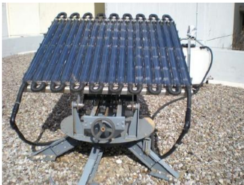
Σχήμα 12.5 Ο φωτοκαταλυτικός αντιδραστήρας στη οροφή του τμήματος Χημείας
