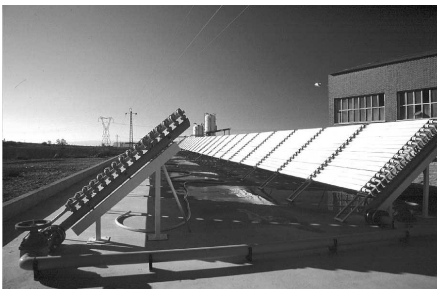
Σχήμα 12.4 Σύνθετοι παραβολικοί συλλέκτες για φωτοκαταλυτικές εφαρμογές (Malato et al., 2002)
