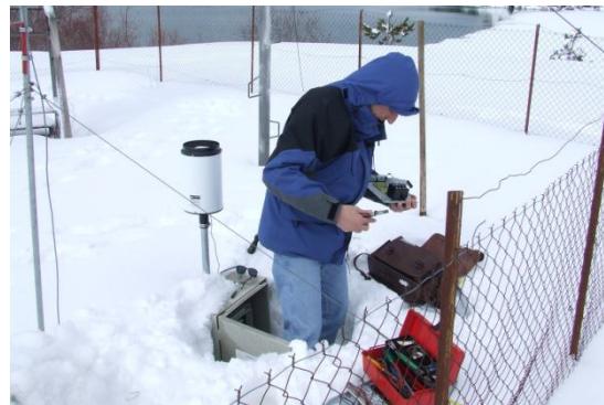
Εικόνα 11: Εγκατάσταση μετεωρολογικού σταθμού υπό αντίξοες καιρικές συνθήκες.
