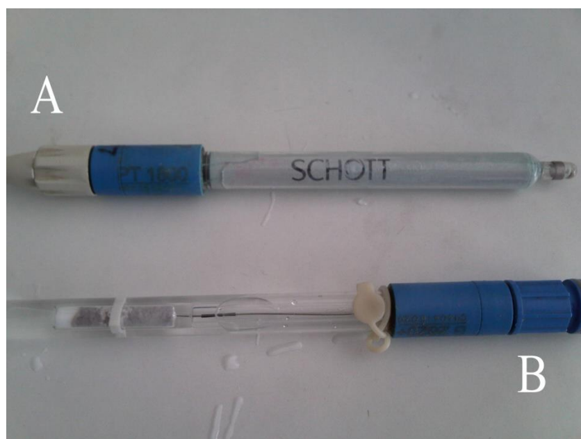
Εικόνα 6.6 A) Βοηθητικό ηλεκτρόδιο μέτρησης ή counter/auxiliary electrode, B) ηλεκτρόδιο αναφοράς χλωριούχου αργύρου
