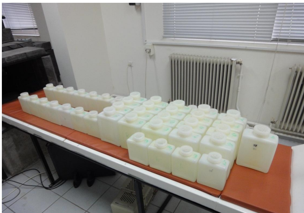
Σχήμα 3.6: Φωτογραφία τυπικού ομοιώματος τοποθετημένου στη εξεταστική κλίνη του MOA
