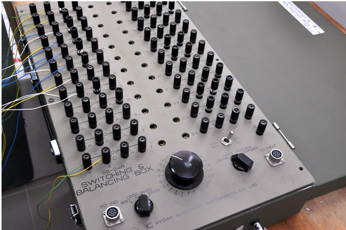
Εικ. 42: Η γέφυρα Wheatstone της εταιρίας KYOWA (Kyowa Electronic Instrument, Tokyo, Japan)
