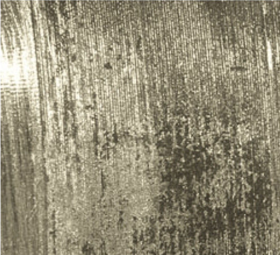
Εικ. 5: Μικροσκοπική εικόνα (μεγέθυνση X 10) αρθρούμενης επιφάνειας στυλεού-αυχένος συστήματος από Co-Cr-Mo. [Αναπαραγωγή από Kor et al. Proximal Component Modularity in THA—At What Cost?: An Implant Retrieval Study. Clinical Orthopaedics and Related Research. 2011 Nov 3 ]
