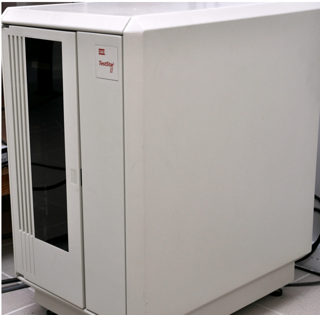
Εικ. 44: Το σύστημα λήψης σήματος (MTS TestStar II ® data acquisition system)
