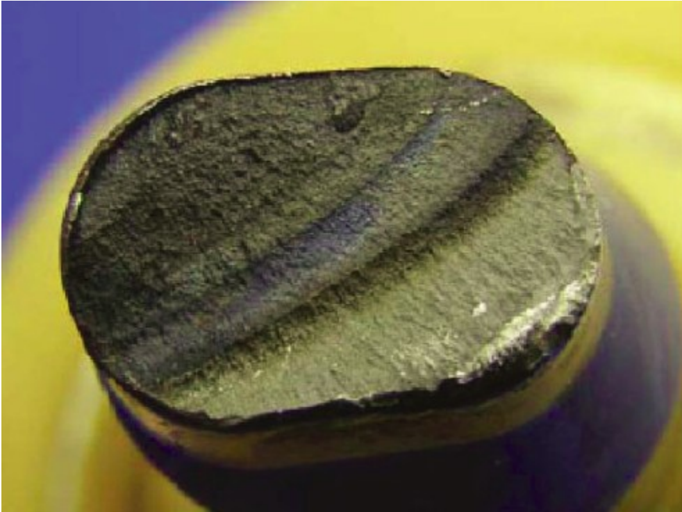
Εικ. 4: Εικόνα αυχένος μετά από θραύση εκ κοπώσεως [Αναπαραγωγή από Grupp et al. Modular titanium alloy neck adapter failures in hip replacement--failure mode analysis and influence of implant material. BMC Musculoskelet Disord. 2010;11:3 ]
