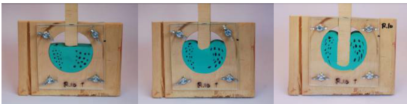
Εικόνα 51: Πίεση σε δύο στάδια, στο πρώτο μέχρι τη μέση της μήτρας, ενώ στο δεύτερο πλήρως.
