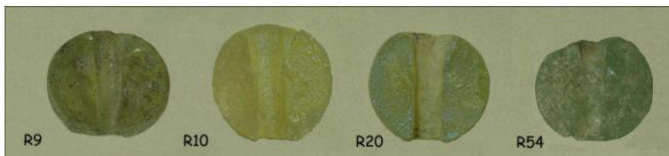
Εικόνα 29: Τα δείγματα R.9, R.10, R.20, R.54. Χαρακτηριστικό των δειγμάτων αυτών είναι ότι έχουν παρόμοια διάμετρο, ενώ το ύψος έχει μεγαλύτερη διακύμανση.
