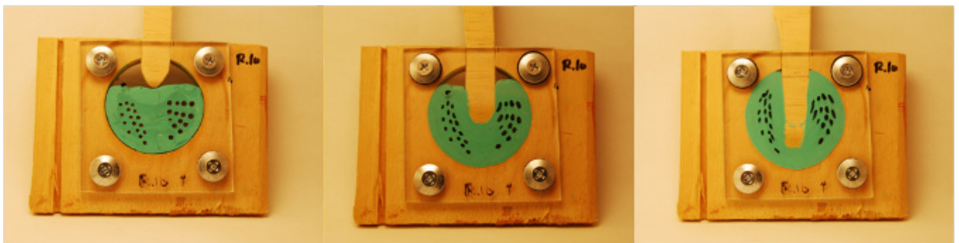
Εικόνα 55: Εμπύση σε δύο στάδια, στο πρώτο μέχρι τη μέση, ενώ στο δεύτερο σε όλο το μήκος της μήτρας. Η σφήνα έχει οξύ άκρο.
