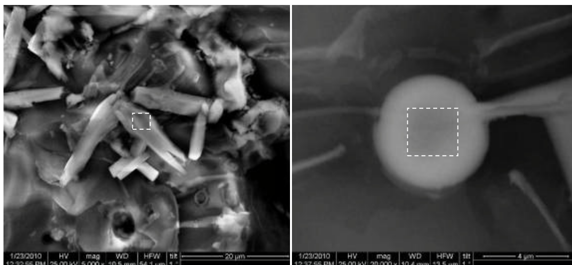
Εικόνα 67: Μεγέθυνση των περιοχών Α και Β που εντοπίστηκαν στο εφυάλωμα του δείγματος Ε.1.
