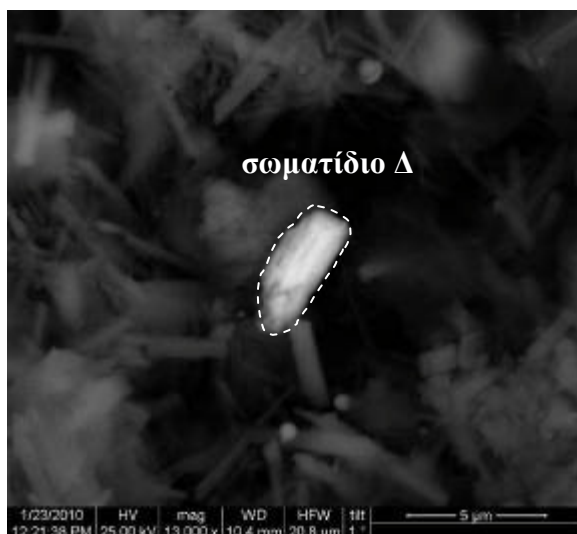
Εικόνα 83: Σωματίδιο Δ που εντοπίστηκε στο εφυάλωμα του δείγματος Ε.7.
