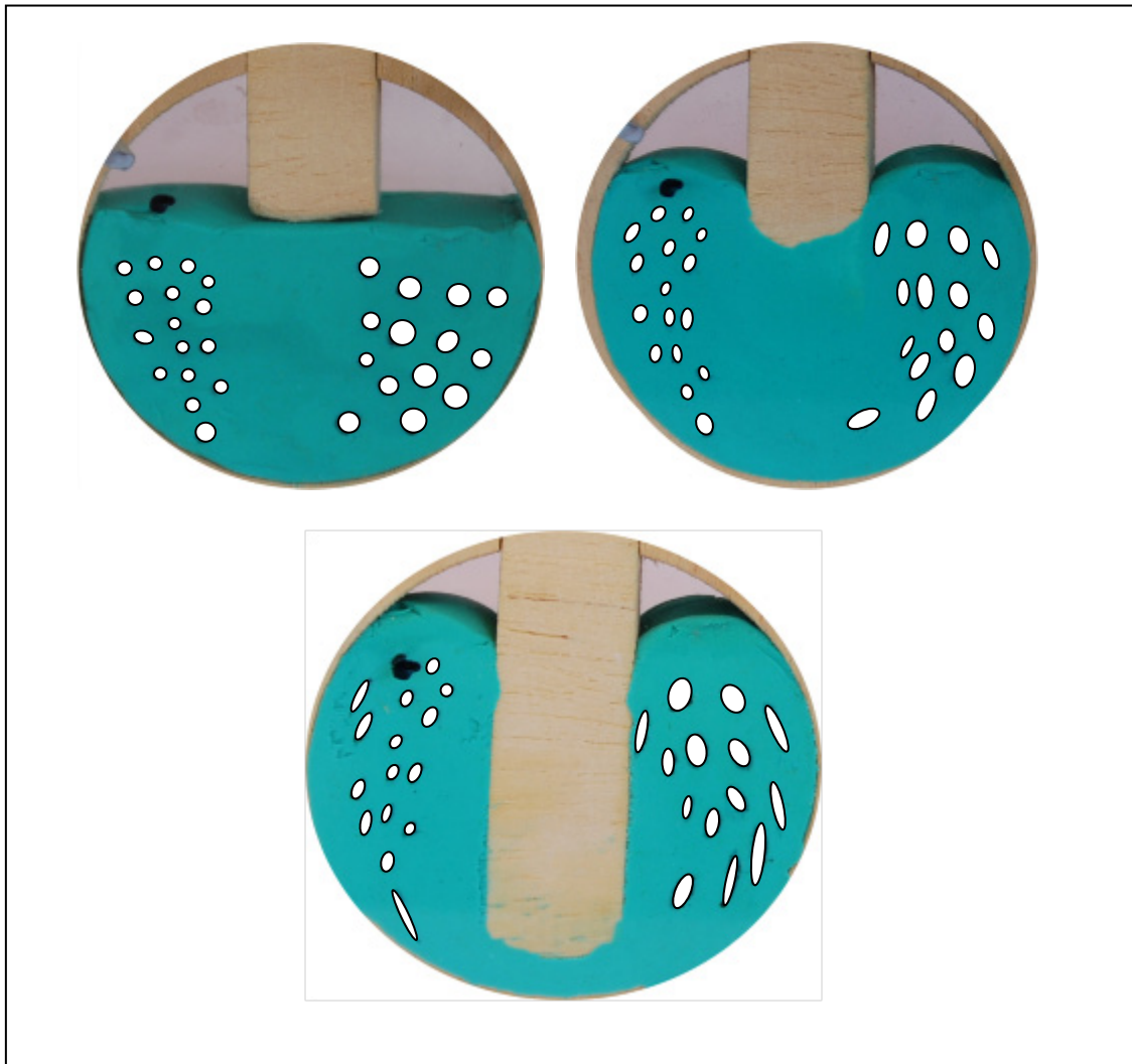
Εικόνα 52: Τα δύο στάδια εμπέσης και το τελικό σχήμα που αποκτούν οι «φυσαλίδες».
