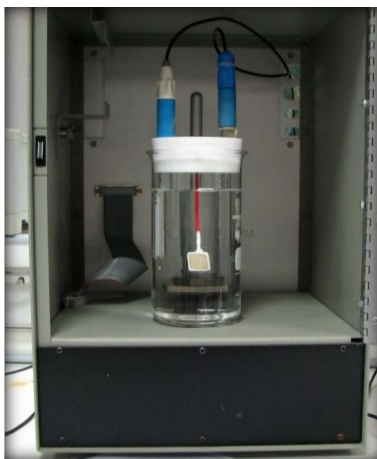
Σχήμα 6.14 Διάταξη ηλεκτροχημικού κελίου για ποτενσιοδυναμικές πολώσεις
