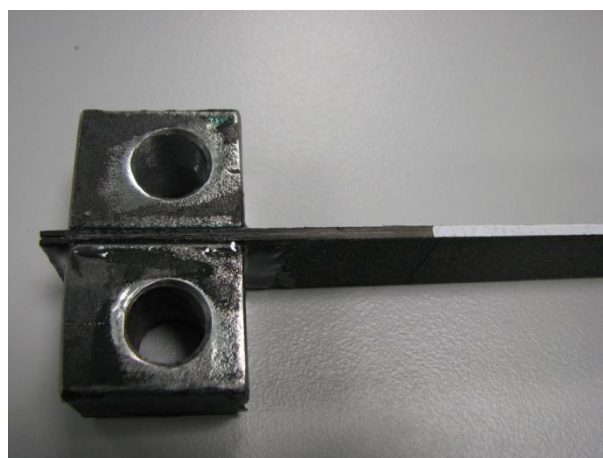
Σχήμα 5.12 Χαρακτηριστική εικόνα των δοκιμών για την δοκιμή Mode I Interlaminar Fracture Toughness
