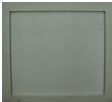
Σχήμα 4.9 Απεικόνιση καλουπιού ελαστομερούς σιλικόνης με τη μορφή «πάνελ» για την κατασκευή διαφόρων δοκιμίων.
