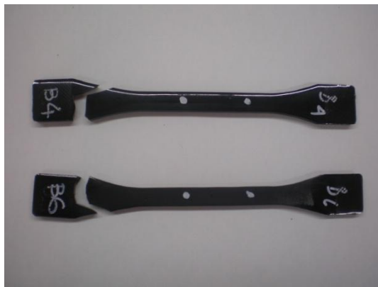
Σχήμα 4.22 Απεικόνιση δοκιμών εφελκυσμού μετά από μη αποδεκτό τρόπο αστοχίας
