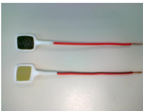
Σχήμα 6.11 Χαρακτηριστική εικόνα δοκιμίων προς μετρήσεις διάβρωσης
