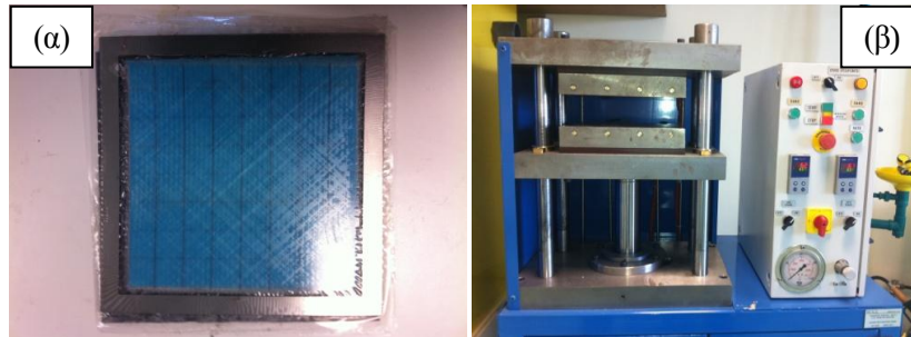
Σχήμα 5.3 (α) Απεικόνιση συστήματος έτοιμο για πολυμερισμό, (β) Πρέσα υψηλών θερμοκρασιών
