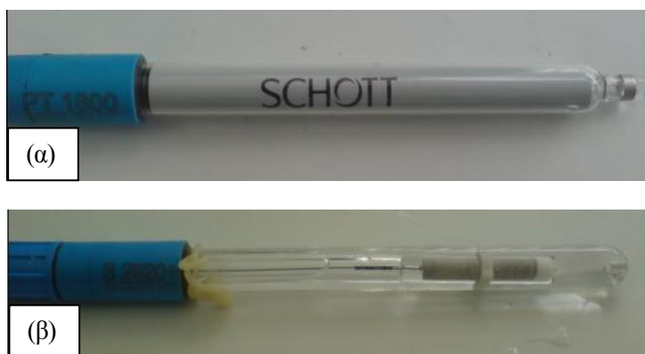
Σχήμα 6.15 (α) Βοηθητικό ηλεκτρόδιο (counter ή auxiliary electrode (AE)) πλατίνας και (β) ηλεκτρόδιο αναφοράς (RE) χλωριούχου αργύρου (Ag/AgCl)
