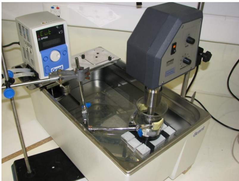
Σχήμα 4.5 Πειραματική διάταξη υπερήχησης εποξειδικής ρητίνης και ΝΣΑ
