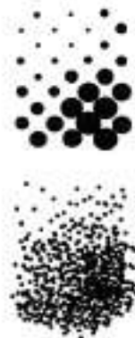
Εικ. 11: α, β) Αναπαραγωγή εικόνας με παραδοσιακό ράστερ (AM) και ράστερ με συχνότητα διαμόρφωσης (FM). Το AM ράστερ δημιουργεί διαβαθμίσεις τόνων με κουκκίδες που έχουν διαφορετικό μέγεθος και ισαπέχουν μεταξύ τους, ενώ το FM ράστερ με κουκκίδες που έχουν όλες το ίδιο μέγεθος και απαντούν σε διαφορετική συχνότητα. γ, δ) η ίδια διαδικασία σε έγχρωμη αναπαραγωγή.
