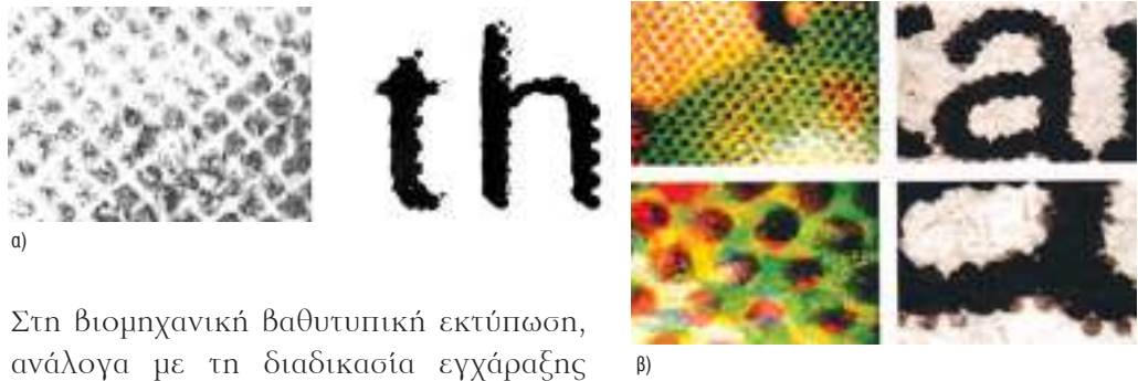
Εικ. 13: Εκτυπωτικά χαρακτηριστικά της βαθυτυπίας: α) μαυρόασπρης, β) έγχρωμης.
