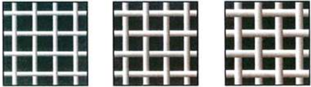
Εικ. 3.6: Τρεις τύποι πλέγματος με τον ίδιο αριθμό ινών.
