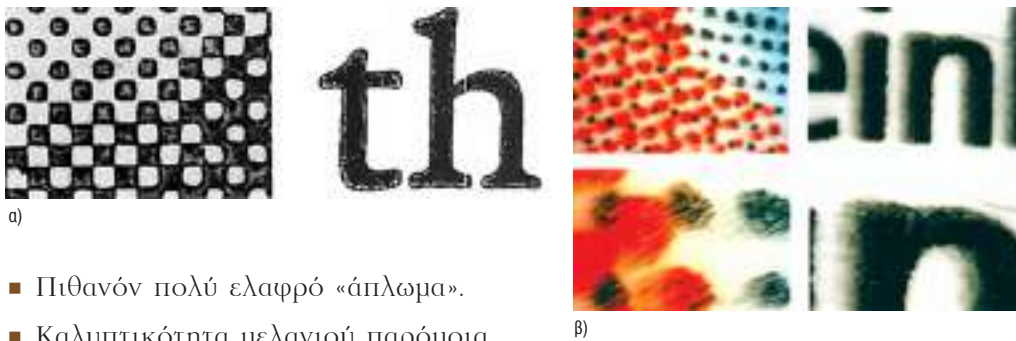
Εικ. 12: α) Εκτυπωτικά χαρακτηριστικά της υψιτυπίας, β) εκτυπωτικά χαρακτηριστικά της έγχρωμης έμμεσης υψιτυπίας (Letterset).
