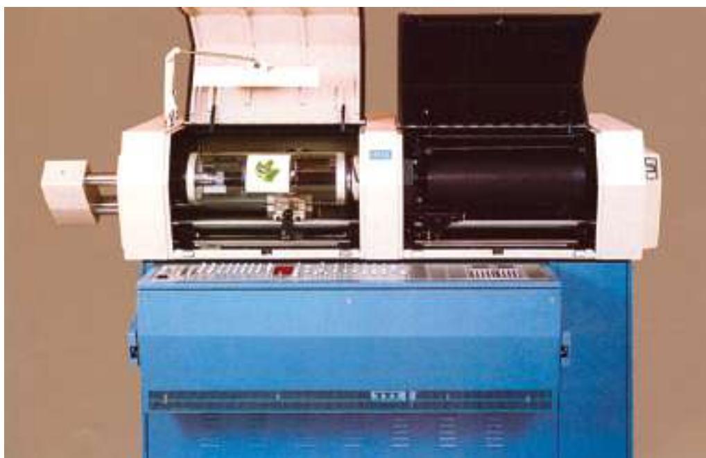
Εικ. 4.13: Χρωμογράφος Β' γενεάς: στο πρώτο τύμπανο (ανάλυσης) τοποθετείται το πρωτότυπο και στο δεύτερο τύμπανο (τύμπανο εγγραφής) τοποθετείται το φιλμ με το ράστερ επαφής.
