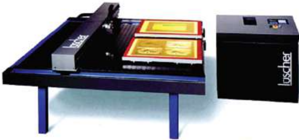
Εικ. 4.10: Σύστημα Computer to screen για την εικονοποίηση με Inkjet (mini Jet-Screen, Lüscher). (πηγή: Handbook of Print Media )
