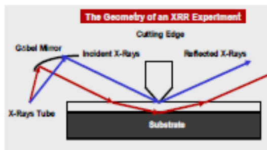
Σχήμα 4.10: Η γεωμετρία ενός πειράματος ανακλαστικότητας Ακτίνων-X.
