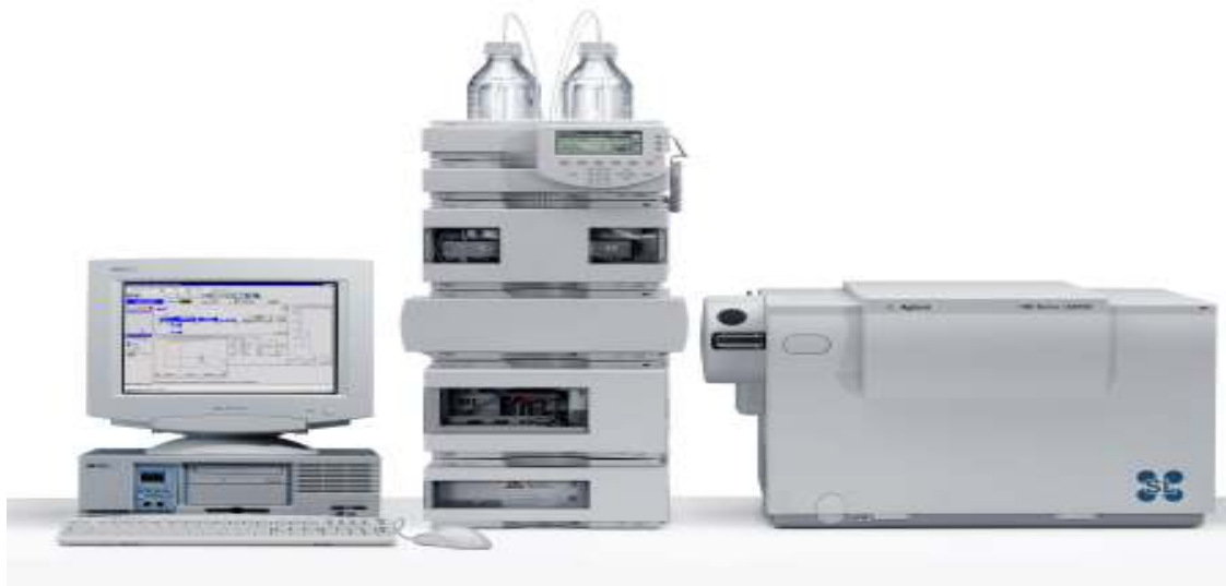
Σχήμα 1.7. Σύστημα υγρής χρωματογραφίας σε σύζευξη με φασματογράφο μάζας με ιοντισμό με ηλεκτροψεκασμό ( LC-ESI- MS).
