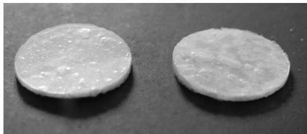
Εικόνα 26: Δισκία KBr που παρασκευάζονται για τη μελέτη δειγμάτων με φασματοσκοπία υπερύθρου.
