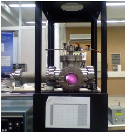
Σχήμα 2.7: Η διάταξη reactive magnetron sputtering.
