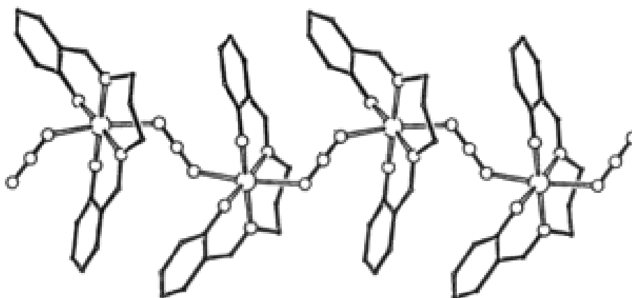
Σχήμα 20 Απεικόνιση του 1D ουδέτερου πολυμερούς με τύπο [\text{Mn}^{\text{III}}(\text{N}_3)(\text{salpn})]_n [19].
