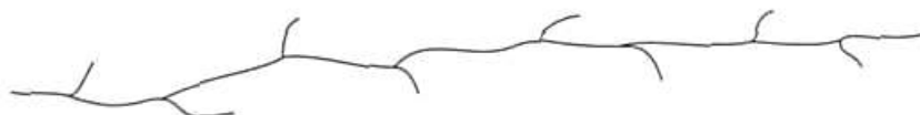
Σχήμα 1.17 Σχηματική αναπαράσταση των αλυσίδων του γραμμικού πολυαιθυλενίου χαμηλής πυκνότητας LLDPE [Καραγιαννίδης Γ., Σιδερίδου Ε., 2006].
