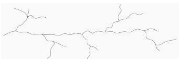
Σχήμα 1.15 Σχηματική αναπαράσταση των αλυσίδων του διακλαδωμένου πολυαιθυλενίου χαμηλής πυκνότητας LDPE [Καραγιαννίδης Γ., Σιδερίδου Ε., 2006].
