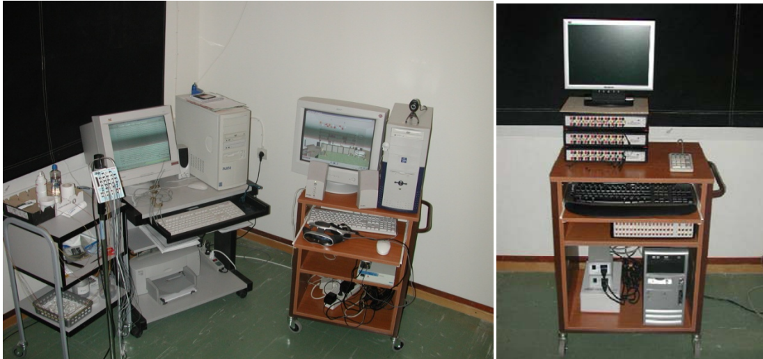
Σχήμα 8-9. Τα συστήματα ψηφιακής ηλεκτροεγκεφαλογραφίας της Μονάδας Τεχνολογιών Αγωγής. Αριστερά το σύστημα για κλινική κυρίως χρήση της Micromed και αριστερά το σύστημα για εργαστηριακούς σκοπούς της gtec στο οποίο έγινε ένα μέρος από την επεξεργασία των δεδομένων. Στο κέντρο το σύστημα εικονικής πραγματικότητας.
