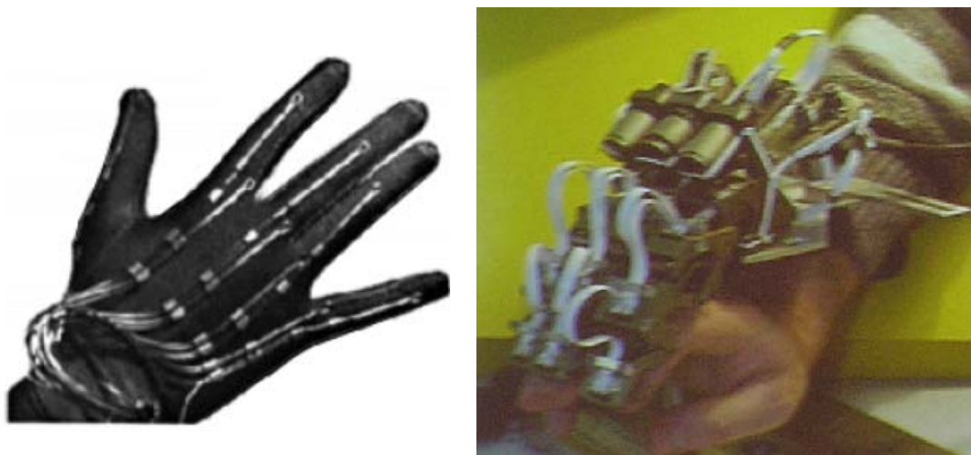
Σχήμα 2-2. Γάντι δεδομένων (αριστερά) και εξωσκελετός (δεξιά).
