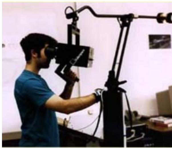
Σχήμα 2-8. Παράδειγμα διάταξης boom.
