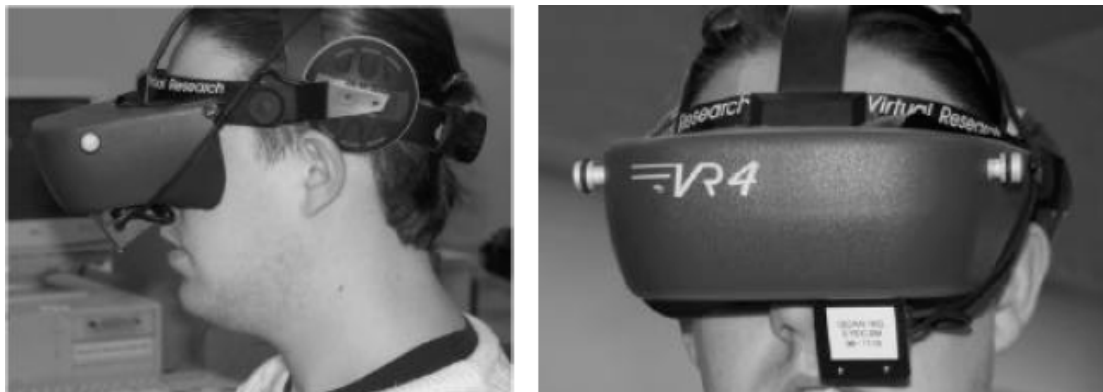
Σχήμα 2-6. Οθόνη ΕΠ προσαρμοσμένη στο κεφάλι του χρήστη (HMD) (Pelz et al. 1999).
