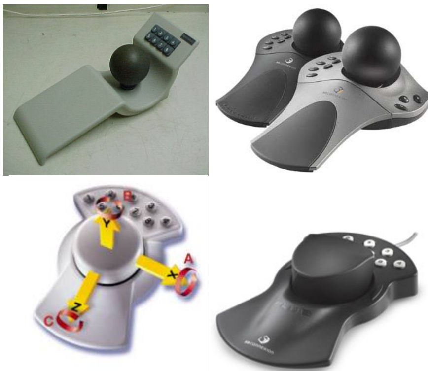
Σχήμα 2-3. Διάφοροι τύποι Spaceball (άνω) και spacemouse (κάτω).
