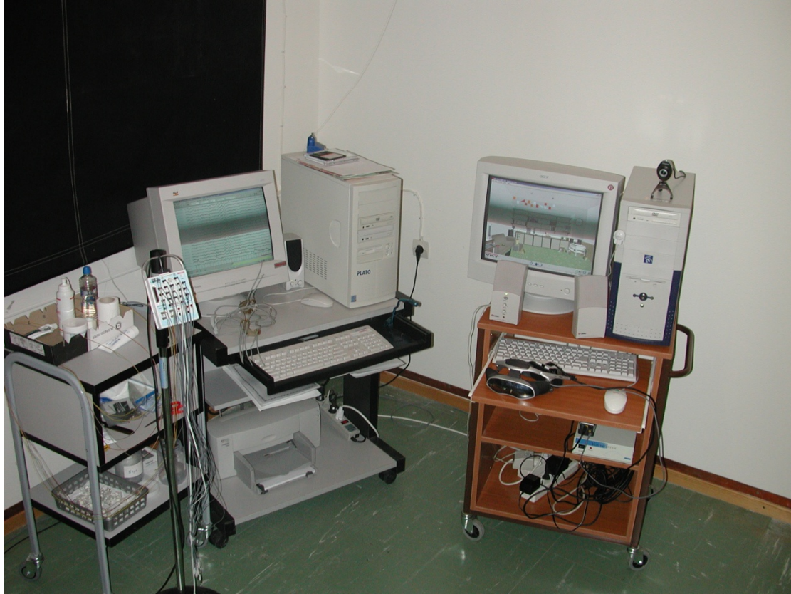
Σχήμα 5-3. Ο εξοπλισμός της Μονάδας Τεχνολογιών Αγωγής. Στα αριστερά εικονίζεται το σύστημα ηλεκτροεγκεφαλογραφίας (System 98 της Micromed) και δεξιά το σύστημα εικονικής πραγματικότητας.
