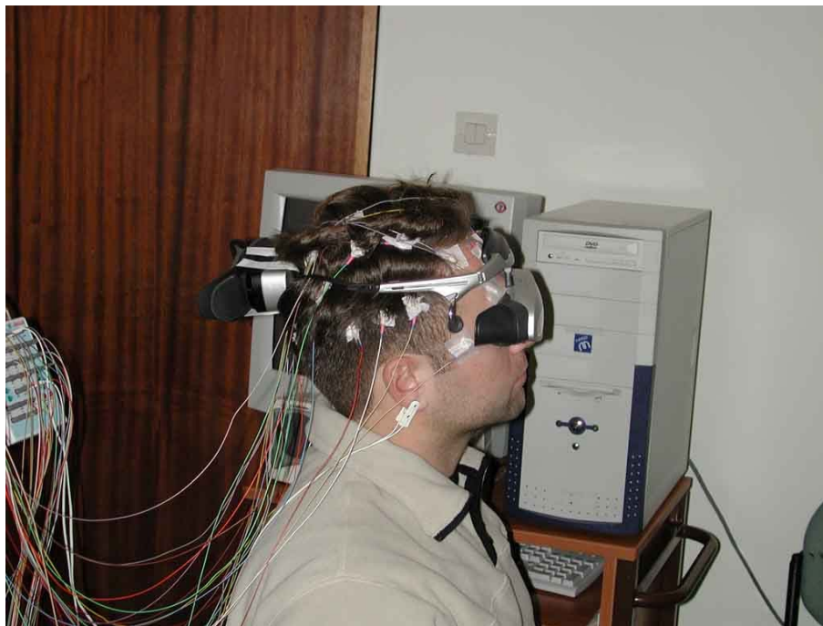
Σχήμα 8-10. Υποκείμενο με όλον το σχετικό εξοπλισμό για το εικονικό περιβάλλον και το σύστημα ηλεκτροεγκεφαλογραφίας.
