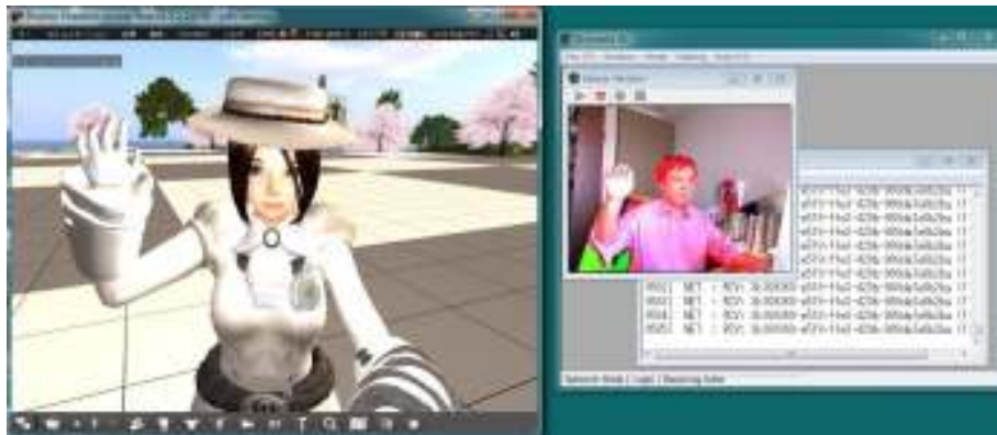
Σχήμα 5.6 Μεταφορά κίνησης από το kinect στο OpenSim
