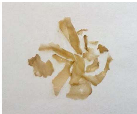
Σχήμα Γ.3: Μη επιτυχής μεμβράνη με τη μέθοδο διαλυμάτων χρησιμοποιώντας νερό ως διαλύτη.
