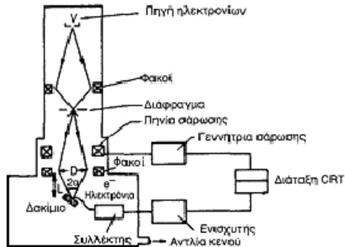
Σχήμα Β.49. Σχηματικό διάγραμμα του SEM
