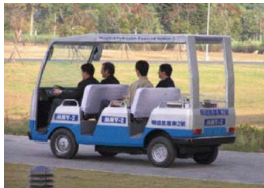
Σχήμα Β.14: Αυτοκίνητο ανοιχτού τύπου με χρήση κελιών καυσίμου μεμβράνης ανταλλαγής πρωτονίων 28
