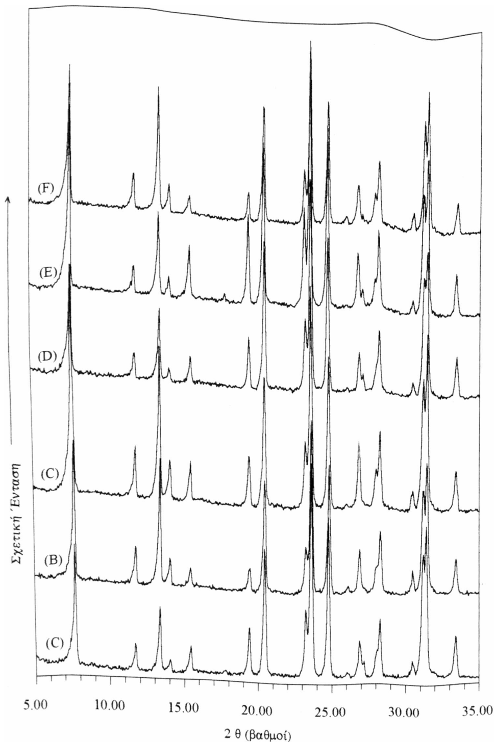
Εικόνα VIII.13. Ακτινογραφήματα σκόνης XRD των ζεόλιθων οφρετίτη: τύπος ναπού κρυσταλλωθείς στους 150°C για 113 ώρες από ένα μίγμα 10,0Na 2 O-1,00Al 2 O 3 -13,9SiO 2 -100,0Γλυκερίνη-81,2H 2 O-2,18KCl (A), πύρωση του A-δείγματος για 5 ώρες στους 500°C (B), αμμωνιοανταλλαγμένο B-δείγμα (C), τύπος ναπού κρυσταλλωθείς στους 120°C για 36 ημέρες από το μίγμα με την ίδια σύσταση όπως το A-δείγμα (D), αμμωνιοανταλλαγμένο D-δείγμα (E), πυρωμένο D-δείγμα (F).
