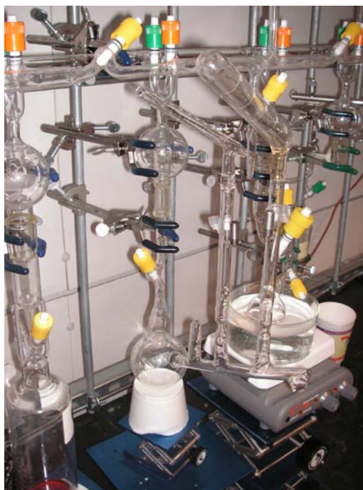
Σχήμα 4.34: Φωτογραφία της συσκευής πολυμερισμού, κατά την διαδικασία της απαέρωσης.
