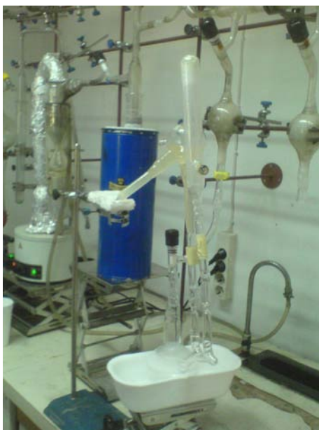
Σχήμα 4.49: Συσκευή συμπολυμερισμού για τα δείγματα A-b-B, κατά την απαέρωση στην γραμμή κενού.
