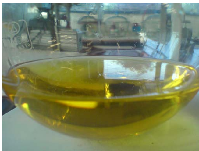
Σχήμα 4.21: Αναπαράσταση του χρώματος του Πολυ(στυρυλολιθίου), ( \text{PSLi}^+ ) σε διαλύτη βενζόλιο κατά τον πολυμερισμό του στυρενίου.
