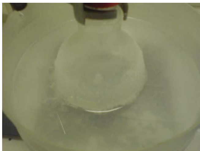
Σχήμα 4.30: Φωτογραφία της αντίδρασης της οξείδωσης της συστάδας του υδροβοριωμένου πολυβουταδιενίου κατά το λουτρό ξυλενίου/αζώτου.
