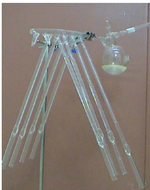
Σχήμα 4.6: Φωτογραφία της αμπουλοσυσκευής με τον απαρχητή σε αραιώση.
