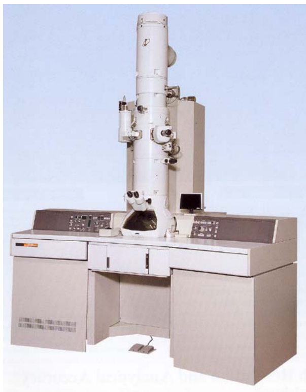
Σχήμα 3.17: Φωτογραφία πειραματικής διάταξης TEM.
