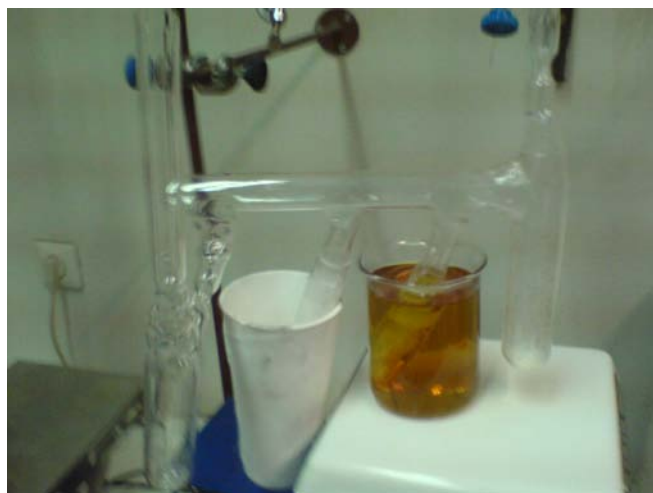
Σχήμα 4.7: Φωτογραφία της διαδοχικής εξάχνωσης για τον καθαρισμό του απαρχητή, όπου παρατηρείται και η τελική αμπουλοσυσσκευή.
