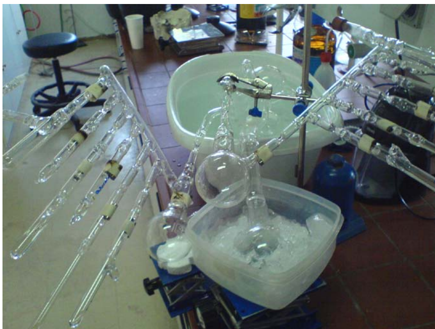
Σχήμα 4.19: Απεικόνιση της συσκευής πολυμερισμού των συμπολυμερών PS-PB κατά την διάρκεια της απόσταξης του διαλύτη.
