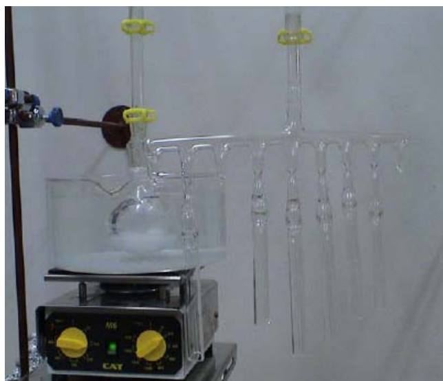
Σχήμα 4.9: Φωτογραφία αμπουλοσυσσκευής για απόσταξη μεθανόλης (δεξιά). Αριστερά παρατηρείται η φιάλη της μεθανόλης σε \text{CaH}_2 και έχει ήδη απαερωθεί τουλάχιστον 2 φορές.
