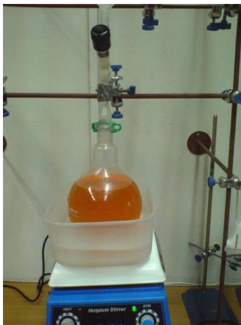
Σχήμα 4.5: Φωτογραφία n-εξανίου υψηλής καθαρότητας σε γραμμή υψηλού κενού, είναι ενδεικτική η παρουσία έντονου πορτοκαλί χρώματος που αποδεικνύει αρκετά ικανοποιητική καθαρότητα.
