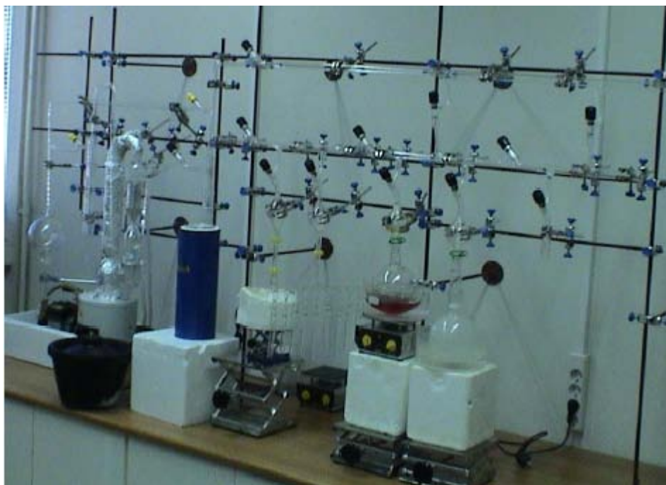
Σχήμα 4.2: Φωτογραφία γραμμής υψηλού κενού, που χρησιμοποιήθηκε για την σύνθεση των πολυμερών της παρούσας εργασίας.
