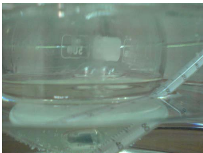
Σχήμα 4.35: Εμφάνιση φυσσαλίδων, κατά τον πολυμερισμό, ένδειξη απελευθέρωσης CO 2 .
