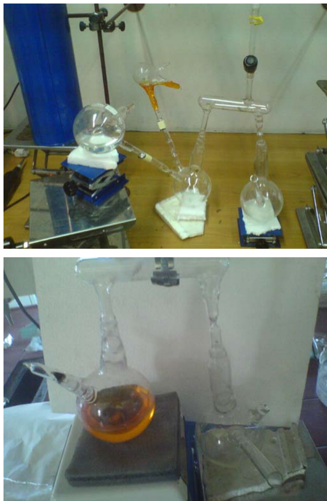
Σχήμα 4.12: Αναπαράσταση της συσκευής καθαρισμού κατά την απαέρωση στην γραμμή υψηλού κενού και κατά την αντίδραση της \text{D}_3 με το Πολυ(στυρολιθίο).
