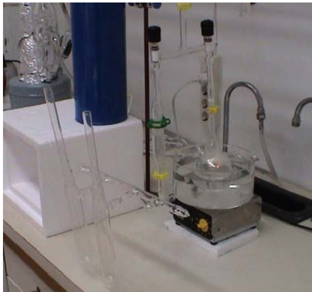
Σχήμα 4.11: Απεικόνιση του καθαρισμού στυρενίου κατά την αντίδραση με το διβουτυλομαγνήσιο.
