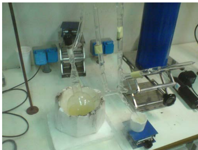
Σχήμα 4.39: Φωτογραφία της συσκευής πολυμερισμού κατά την απαέρωση μετά το πέρας του πολυμερισμού.
