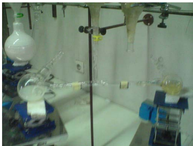
Σχήμα 4.55: Συσκευή για την σύζευξη του ζωντανού κλάδου (πολυδιένιο), (δεξιά) με το πολυπεπτίδιο (αριστερά), κατά την διάρκεια της απαέρωσης στην γραμμή.
