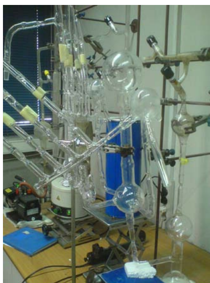
Σχήμα 4.43: Συσκευή πολυμερισμού της συστάδας Α κατά την απαέρωση στην γραμμή υψηλού κενού.
