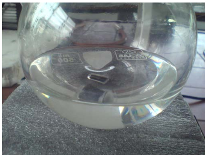
Σχήμα 4.26: Τερματισμός συμπολυμερούς PS-PB 1,2 με μεθανόλη.
