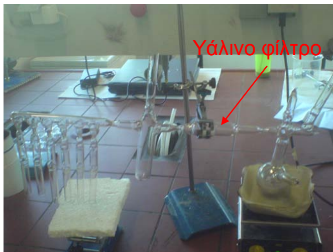
Σχήμα 4.10: Απεικόνιση του σταδίου καθαρισμού του diir με το κάτοπτρο νατρίου.
