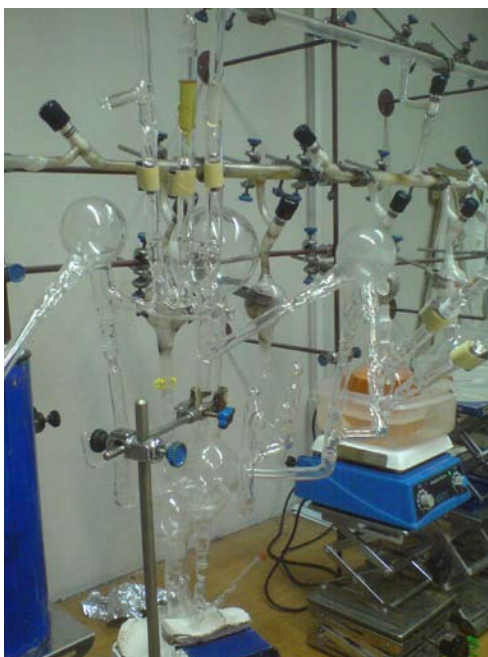
Σχήμα 4.52: Φωτογραφία της συσκευής για την σύνθεση των πολυδιενίων, στην συγκεκριμένη περίπτωση για το PI -1,4 και για το PI -1,2/-3,4.
