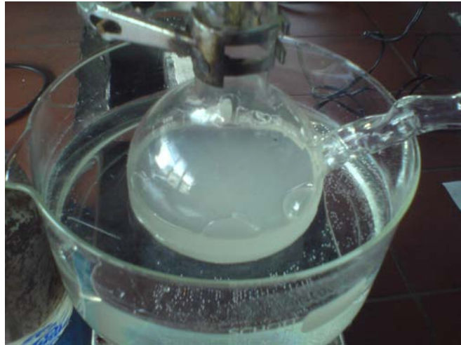
Σχήμα 4.37: Φωτογραφία της έναρξης πολυμερισμού της προστατευμένης τυροσίνης.
