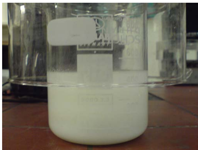
Σχήμα 4.28: Καταβύθιση του συμπολυμερούς σε μεθανόλη.
