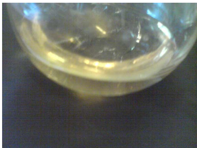
Σχήμα 4.46: Χρωματισμός του διαλύματος του PB_{1,4} μετά την εισαγωγή του φορμαλίνου.
