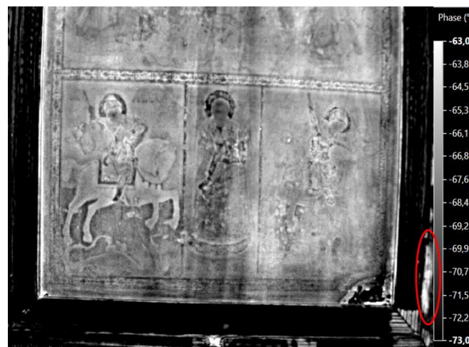
Εικόνα 39. Θερμογράφημα μπροστινής όψης - Σημεία με προσροφημένη υγρασία
