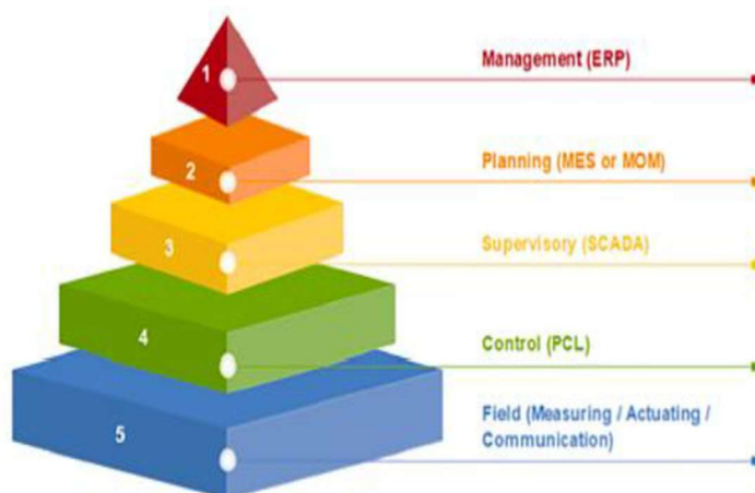
Εικόνα 4.1.1.α: Η παραδοσιακή πυραμίδα βιομηχανικού αυτοματισμού και τα επίπεδα αρχιτεκτονικής SCADA [30].
