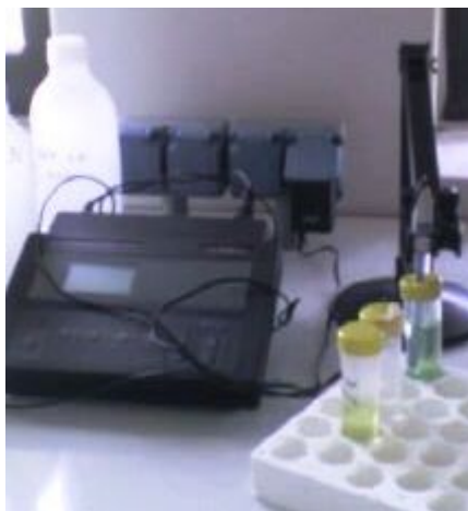
Εικόνα 30: Ηλεκτρονικό pH-μετρο στο βιοχημικό εργαστήριο του Τ.Ε.Ι. Ηπείρου, Α.Α.Τ.
