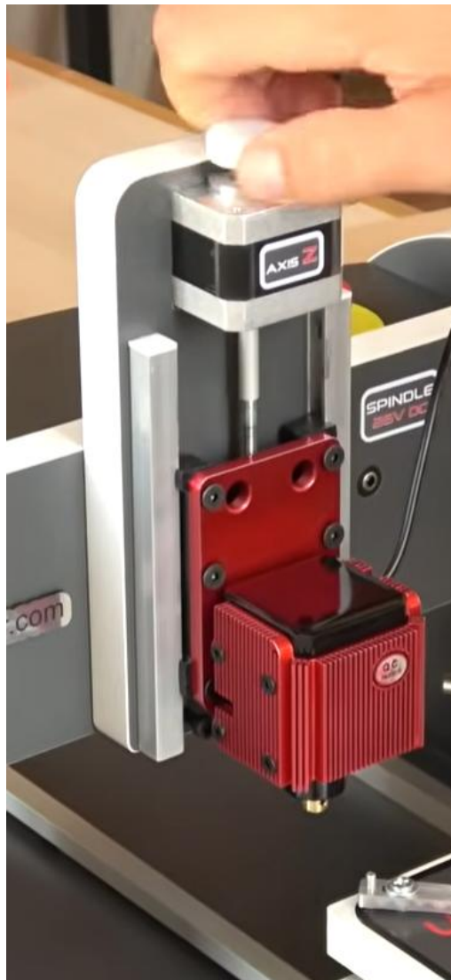
Εικόνα 113: Χειροκίνητη ρύθμιση του άξονα Z στη μηχανή Wegstr CNC μέσω του περιστρεφόμενου κομβίου (λευκό κουμπί).
