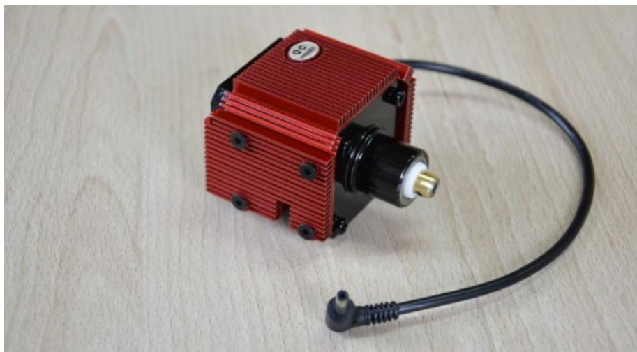
Εικόνα 11: Η κεφαλή (spindle) της επιτραπέζια φρέζα Wegstr CNC.
