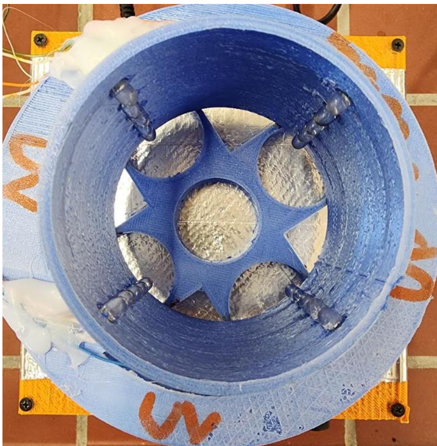
Συσκευή UV, συστοιχία 20 LED Violet 400 nm
