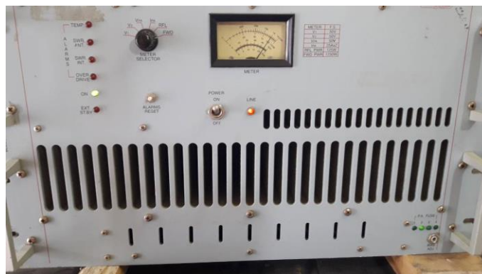
Εικόνα 9: Οδηγός Σήματος, Μοντέλο MODRG 100 M για τον ενισχυτή (LINEAR), Εταιρεία RVR ισχύος 100 Watt
