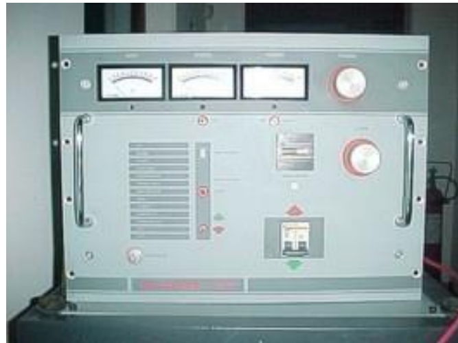
Εικόνα 8 : Πομπός Ιταλικής Κατασκευής της Εταιρείας ELENOS (μοντέλο T2000), ισχύος 2000 Watt
