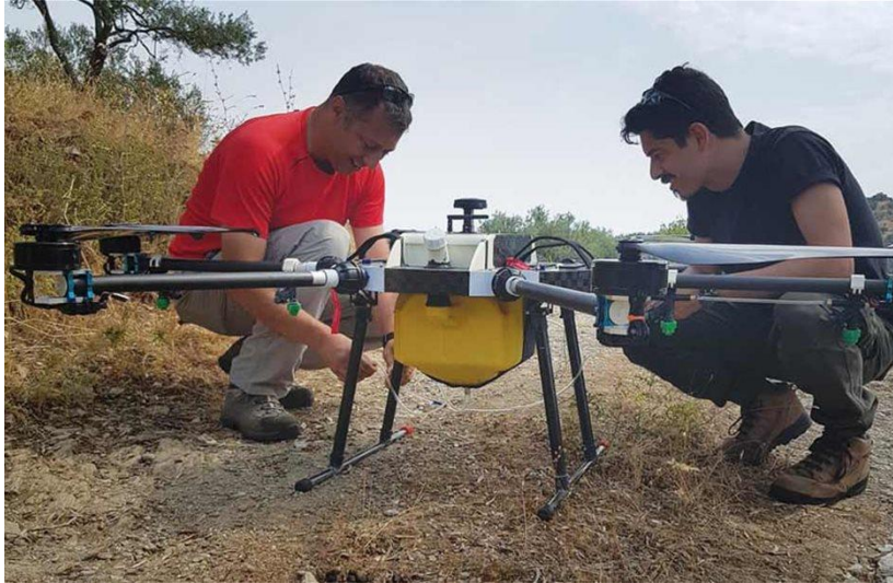
Εικόνα 8 Χρήση UAV για αγροτική εργασία και συγκεκριμένα για φυτοπροστασία σε δυσπρόσιτα σημεία
