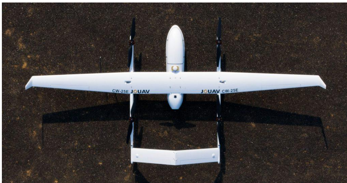
Εικόνα 2. Fixed-wing UAV από την εταιρεία JOUAV με σκοπό την χαρτογράφηση περιοχών
