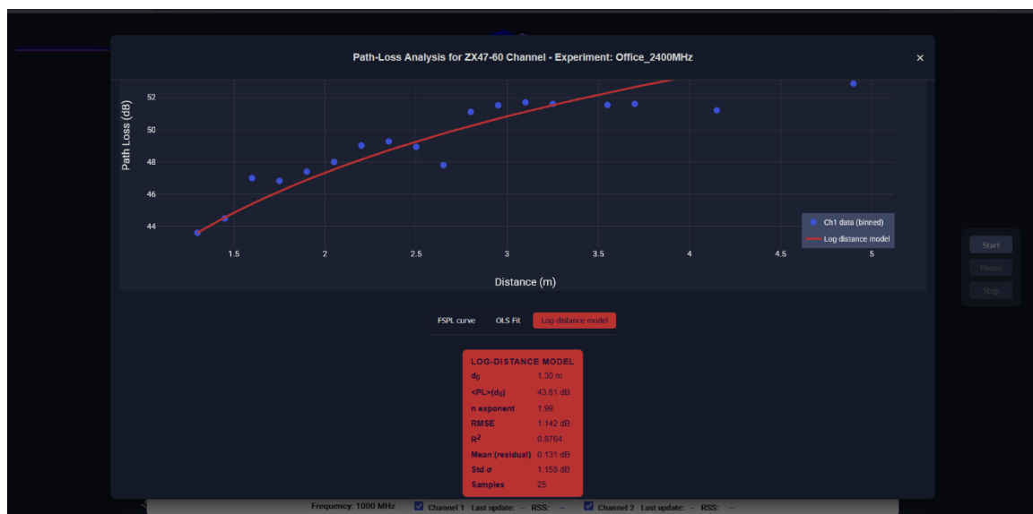
Σχήμα 3.19: Η προσαρμογή και τα αποτελέσματα του μοντέλου εξασθένησης διαδρομής λογαριθμικής απόστασης.
