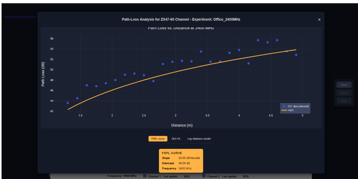
Σχήμα 3.17: Προσθήκη καμπύλης βάσει του μοντέλου εξασθένησης διαδρομής ελεύθερου χώρου (FSPL)
