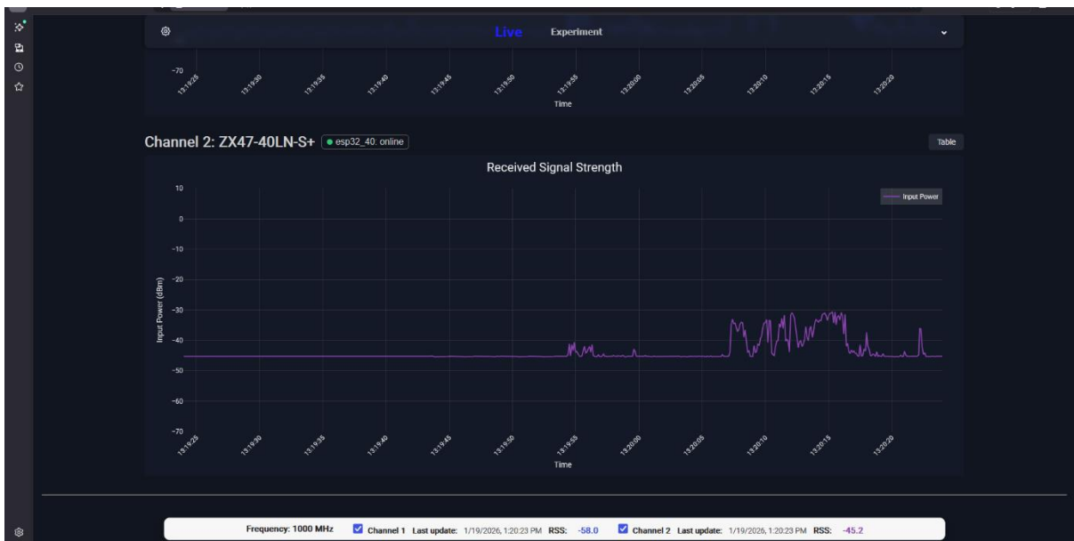
Σχήμα 3.5: Το αρχικό περιβάλλον της ιστοσελίδας (Live) με τα δύο γραφήματα παρακολούθησης της ζωντανής ροής από τους δύο ανιχνευτές – του ZX47-60LN-S+ (πάνω) και του ZX47-40LN-S+ (κάτω).
