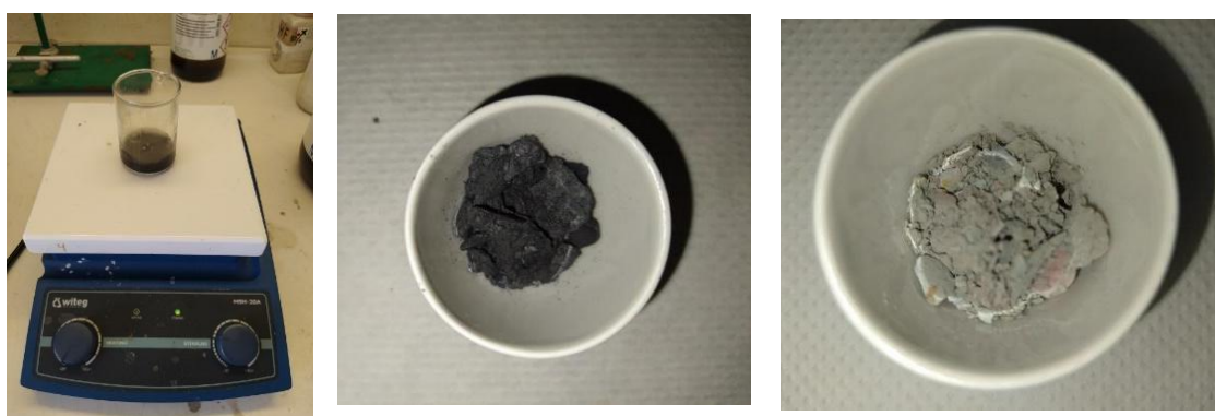
Εικόνα 4.14: (αριστερά) Εκπλύσεις με νιτρικό και υδροφθορικό οξύ, (κέντρο) Εκπλυμένο καρβίδιο του πυριτίου πριν την έψηση στους 900°C (δεξιά) Καρβίδιο του πυριτίου μετά την έψηση στους 900°C.
