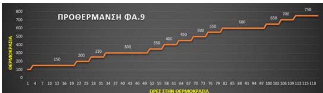
Εικόνα Π.16: Αναλυτική καμπύλη προθέρμανσης πυριμάχων μαζών, στην επισκευή του κλιβάνου τήξης Νο1.
