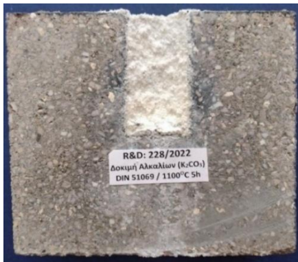
Εικόνα 7.1: Ζώνες διάβρωσης συνθέσεων 228/2022 και 12/23 σύμφωνα με το DIN 51069 με K_2CO_3 στους 1100\text{ }^\circ\text{C} .
