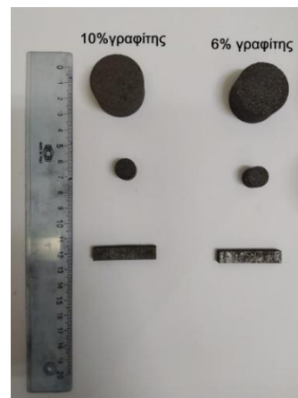
Εικόνα 4.16: (αριστερά) Πυρίμαχο καλυμμένο με άνθρακα πριν την πυροσυσσωμάτωση στους 1400 °C, (δεξιά) Δοκίμια μαγνησίας-άνθρακα με διαφορετικά ποσοστά γραφίτη.
