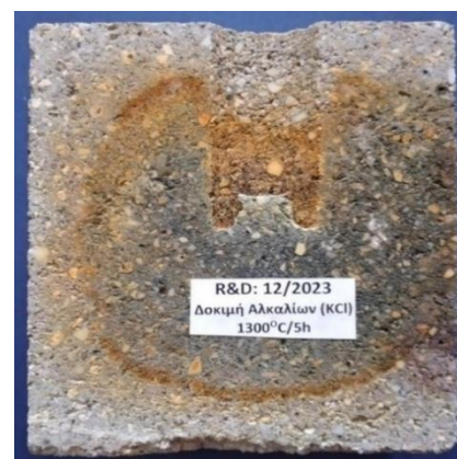
Εικόνα 7.8: Ζώνες διάβρωσης συνθέσεων 228/2022 και 12/2023 με χλωριούχο κάλιο ( \text{KCl} ) στους 1300 °C.
