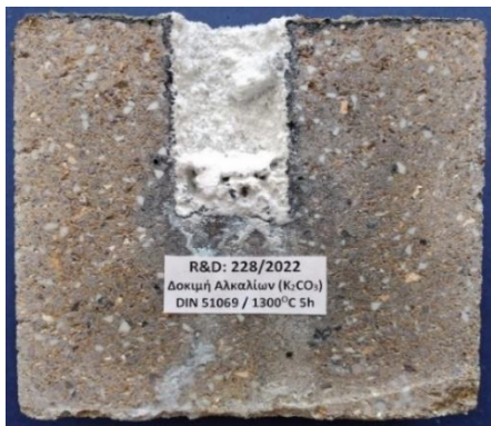
Εικόνα 7.2: Ζώνες διάβρωσης συνθέσεων 228/2022 και 12/23 σύμφωνα με το DIN 51069 με K_2CO_3 στους 1300\text{ }^\circ\text{C} .
