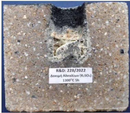
Εικόνα 7.4: Ζώνες διάβρωσης συνθέσεων 228/2022 και 12/2023, με θειικό κάλιο ( K_2SO_4 ) στους 1300 °C.
