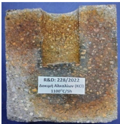
Εικόνα 7.7: Ζώνες διάβρωσης συνθέσεων 228/2022 και 12/2023 με χλωριούχο κάλιο ( \text{KCl} ) στους 1100 °C.
