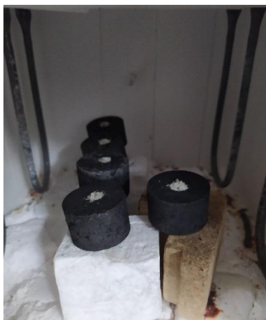
Εικόνα 6.4: Πυρίμαχα μαγνησίας-άνθρακα πριν το τεστ οξείδωσης. Τα δοκίμια πληρώθηκαν με συνθετικό διαβρωτικό μέσο, με σκοπό τη μελέτη της συμπεριφοράς τους έναντι διάβρωσης.
