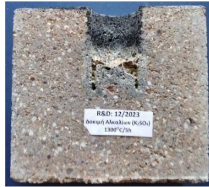
Εικόνα 7.4: Ζώνες διάβρωσης συνθέσεων 228/2022 και 12/2023, με θειικό κάλιο ( K_2SO_4 ) στους 1300 °C.
