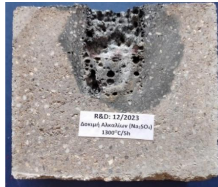
Εικόνα 7.6: Ζώνες διάβρωσης συνθέσεων 228/2022 και 12/2023 με θειικό νάτριο ( \text{Na}_2\text{SO}_4 ) στους 1300 °C.
