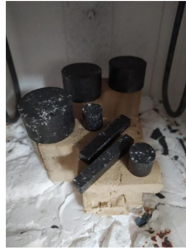
Εικόνα 4.17: Πυρίμαχα μαγνησίας άνθρακα (αριστερά 100% nano-TiO 2 , δεξιά 75%Al 2 O 3 -25%TiO 2 ) πριν τη θερμική επεξεργασία στους 200 °C.
