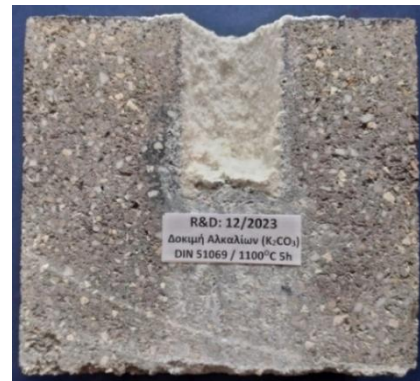
Εικόνα 7.1: Ζώνες διάβρωσης συνθέσεων 228/2022 και 12/23 σύμφωνα με το DIN 51069 με K_2CO_3 στους 1100\text{ }^\circ\text{C} .
