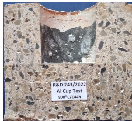
Εικόνα 7.26: (αριστερά) Αποτελέσματα δοκιμής διάβρωσης δοκιμίου 191/2021 και δοκιμίου 243/2022 (δεξιά) (προέψηση 1000 °C για 5 ώρες).
