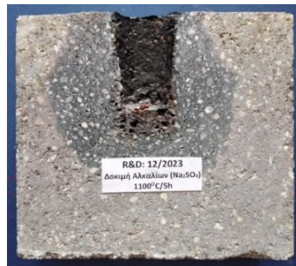
Εικόνα 7.5: Ζώνες διάβρωσης συνθέσεων 228/2022 και 12/2023 με θειικό νάτριο ( Na_2SO_4 ) στους 1100 °C.
