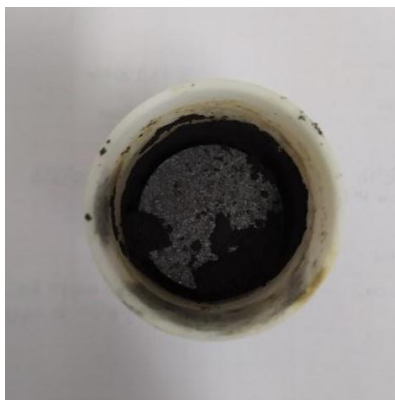
Εικόνα 4.16: (αριστερά) Πυρίμαχο καλυμμένο με άνθρακα πριν την πυροσυσσωμάτωση στους 1400 °C, (δεξιά) Δοκίμια μαγνησίας-άνθρακα με διαφορετικά ποσοστά γραφίτη.
