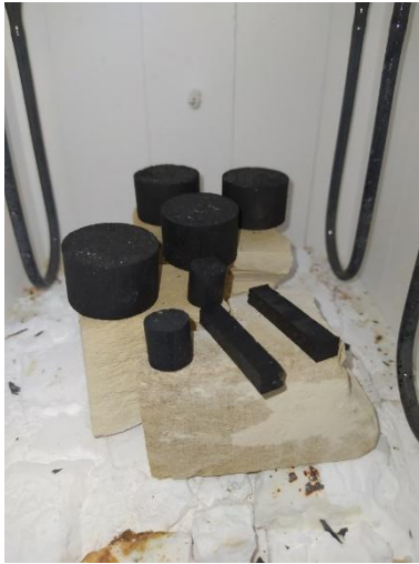
Εικόνα 4.17: Πυρίμαχα μαγνησίας άνθρακα (αριστερά 100% nano-TiO 2 , δεξιά 75%Al 2 O 3 -25%TiO 2 ) πριν τη θερμική επεξεργασία στους 200 °C.
