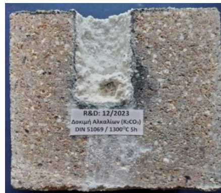
Εικόνα 7.2: Ζώνες διάβρωσης συνθέσεων 228/2022 και 12/23 σύμφωνα με το DIN 51069 με K_2CO_3 στους 1300\text{ }^\circ\text{C} .
