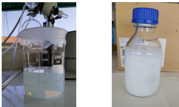
Εικόνα 4.6: (αριστερά) Αρχικό αιώρημα νανοσωματιδίων πυριτίας πριν τη χρήση περιστροφικού εξατμιστή, (δεξιά) Τελικό αιώρημα νανοσωματιδίων πυριτίας με χρήση διασπορέα όπως στάλθηκε στην εταιρεία Μαθιός Πυρίμαχα Α.Ε..
