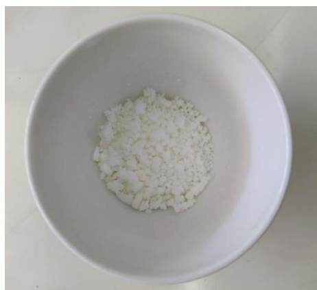
Εικόνα 4.3: Νανοδομημένα οξειδίου του αλουμινίου μετά τους 600 °C και πριν τη λειοτρίβιση.
