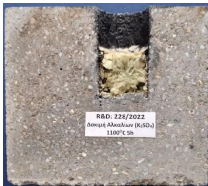
Εικόνα 7.3: Ζώνες διάβρωσης συνθέσεων 228/2022 και 12/2023, με θειικό κάλιο ( K_2SO_4 ) στους 1100\text{ }^\circ\text{C} .
