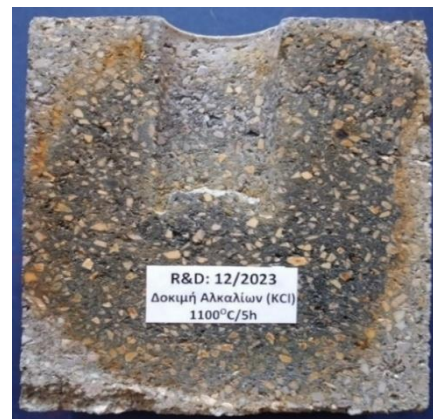
Εικόνα 7.7: Ζώνες διάβρωσης συνθέσεων 228/2022 και 12/2023 με χλωριούχο κάλιο ( \text{KCl} ) στους 1100 °C.
