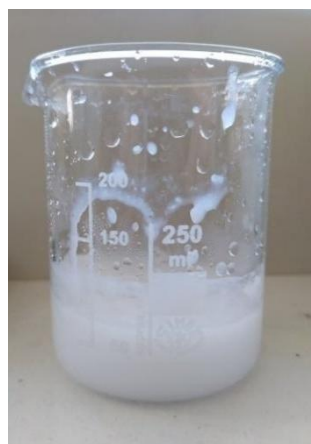
Εικόνα 4.2: (αριστερά) Μηχανική ανάδευση γέλης, (δεξιά) Πύκτωμα που προέκυψε, πριν την ξήρανσή του.
