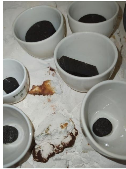
Εικόνα 4.15: (αριστερά) Δοκίμια με 6% γραφίτη μετά την μορφοποίηση, (δεξιά) Δοκίμια με 6% γραφίτη στο φούρνο μέσα σε χωνευτήρια πορσελάνης πριν τους 200 °C.
