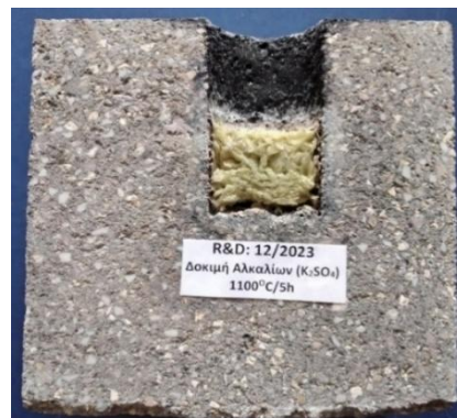
Εικόνα 7.3: Ζώνες διάβρωσης συνθέσεων 228/2022 και 12/2023, με θειικό κάλιο ( K_2SO_4 ) στους 1100\text{ }^\circ\text{C} .
