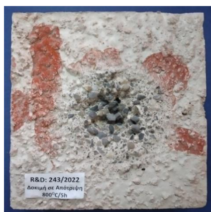
Εικόνα 7.23: Φωτογραφίες από απότριψη δοκιμών εργαστηριακής δοκιμής 243/2022, μετά από προέψηση 800 και 1000 °C για 5 ώρες.
