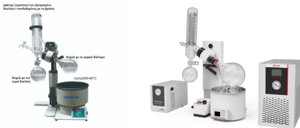
Εικόνα 4.5: (αριστερά) Ο περιστροφικός εξατμιστής RE-2010 της Biobase, (δεξιά) Ο περιστροφικός εξατμιστής EV400 της LabTech με αντλία κενού (Vacuum Pump VP18 PLUS) και το chiller (Chiller SMART H50-500).
