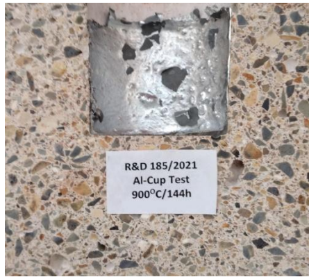
Εικόνα 7.25: Αποτελέσματα δοκιμής διάβρωσης δοκιμίου 185/2021 (προέψηση στους 1000 °C για 5 ώρες).
