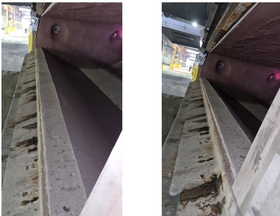
Εικόνα Π.17: Τμήματα πυριμάχων μαζών MAT NANO 80AL/S και MAT NANO 75-AL μετά τη προθέρμανση του κλιβάνου τήξης Νο1.
