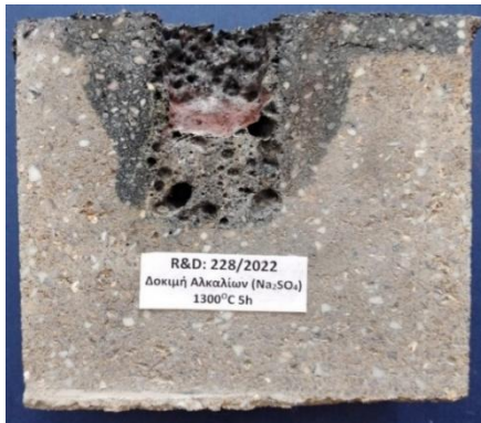
Εικόνα 7.6: Ζώνες διάβρωσης συνθέσεων 228/2022 και 12/2023 με θειικό νάτριο ( \text{Na}_2\text{SO}_4 ) στους 1300 °C.
