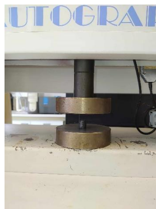
Εικόνα Π.9: (αριστερά) Απεικόνιση δομικής σε μονοαξονική συμπίεση, (δεξιά) Πειραματική διάταξη δοκιμής αντοχής σε θλίψη με εφελκνόμετρο της εταιρείας Shimadzu.
