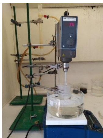
Εικόνα 4.2: (αριστερά) Μηχανική ανάδευση γέλης, (δεξιά) Πύκτωμα που προέκυψε, πριν την ξήρανσή του.
