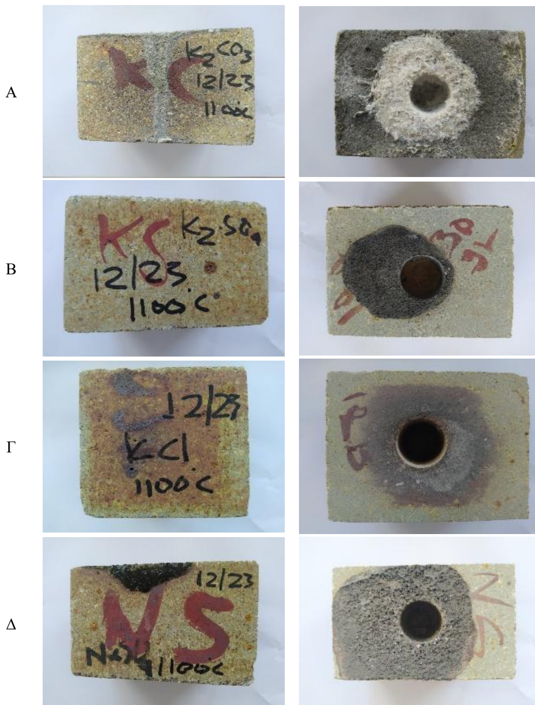
Εικόνα 7.9: Φωτογραφίες δοκιμίων ανδαλουσιτικής σύνθεσης με 8% καρβίδιο του πυριτίου και 2% σε νανοσωματίδια με προσθήκη θειικού καλίου (Α), ανθρακικού καλίου (Β), χλωριούχου καλίου (Γ) και θειικού νατρίου (Δ) σε θερμοκρασία 1100 °C.
