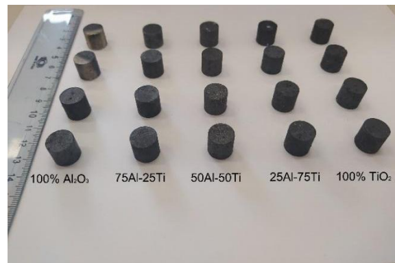
Εικόνα 4.18: Τα δοκίμια μικρής διαμέτρου μετά την πυροσυσσώματωση στους 1400 °C.
