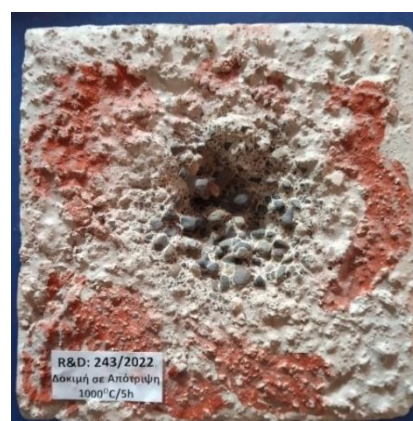
Εικόνα 7.23: Φωτογραφίες από απότριψη δοκιμών εργαστηριακής δοκιμής 243/2022, μετά από προέψηση 800 και 1000 °C για 5 ώρες.
