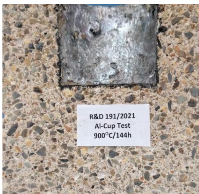
Εικόνα 7.26: (αριστερά) Αποτελέσματα δοκιμής διάβρωσης δοκιμίου 191/2021 και δοκιμίου 243/2022 (δεξιά) (προέψηση 1000 °C για 5 ώρες).
