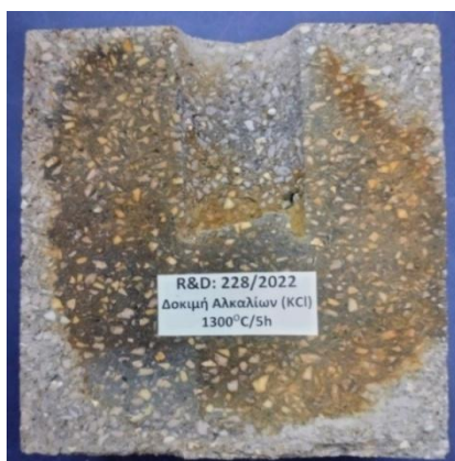
Εικόνα 7.8: Ζώνες διάβρωσης συνθέσεων 228/2022 και 12/2023 με χλωριούχο κάλιο ( \text{KCl} ) στους 1300 °C.
