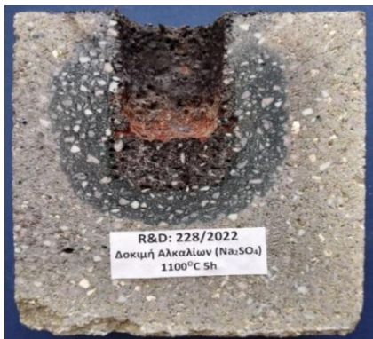
Εικόνα 7.5: Ζώνες διάβρωσης συνθέσεων 228/2022 και 12/2023 με θειικό νάτριο ( Na_2SO_4 ) στους 1100 °C.
