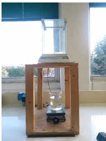
Εικόνα 4.23: Πειραματική διάταξη προσδιορισμού πυκνότητας-πορώδους με τη μέθοδο του Αρχιμήδη.
