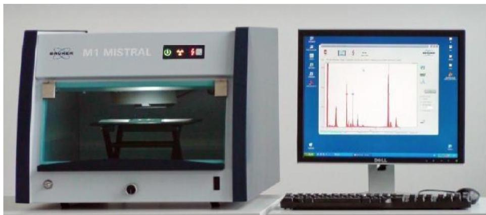
Σχήμα 55. Η διάταξη του M1 Mistral της Bruker αποτελείται από το φασματοσκόπιο αριστερά ενώ απαραίτητη για τη ρύθμιση του οργάνου είναι και η χρήση ηλεκτρονικού υπολογιστή (δεξιά).
