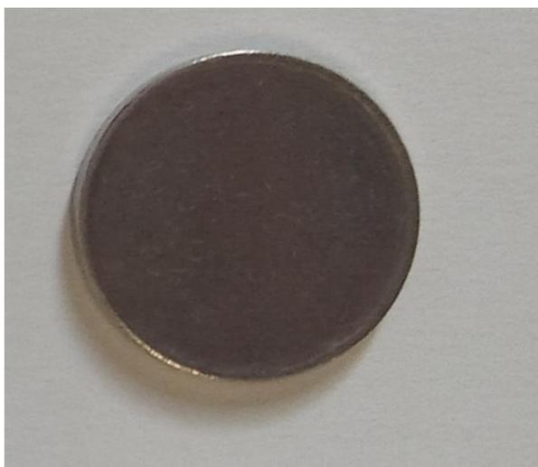
**Σχήμα 70.** Η όψη του κράματος  $Cu_{89}Zn_5Sn_1Al_5$ .
