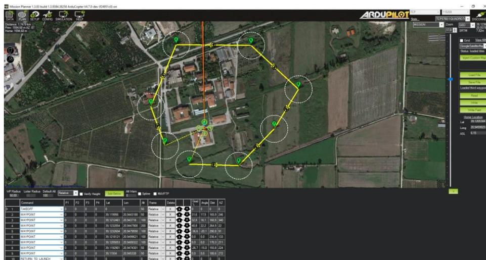
Figure 41 Σχεδίαση αποστολής με waypoints στο Mission Planner
