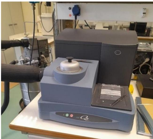
**Εικόνα 4.12:** Οργανολογία Διαφορική Θερμιδομετρίας Σάρωσης, DSC ,Q-20 της TA Instruments.
