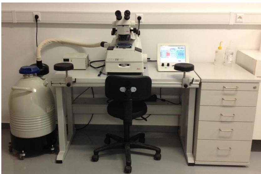
**Εικόνα 6.10:** Μικροτόμος Leica EM, UC7 με τον οποίο προετοιμάστηκαν τα τελικά λεπτά υμένια των συμπολυμερών και των αντίστοιχων μειγμάτων για παρατήρησή τους με Ηλεκτρονική Μικροσκοπία Διέλευσης.
