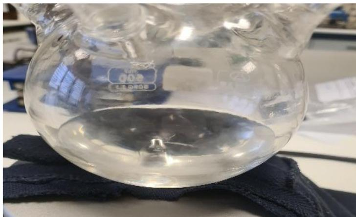
**Εικόνα 5.23:** Παρατηρείται η συσκευή πολυμερισμού που περιέχει ποσότητα τετραϋδροφουρανίου (THF), η οποία είναι ίση με την ποσότητα του βενζολίου και το διάλυμα αφήνεται υπό ανάδευση για τέσσερις (4) ώρες σε θερμοκρασία δωματίου και με το πέρας των 4<sup>ων</sup> ωρών αποθηκεύεται στους -20°C για 7 έως 10 ημέρες.
