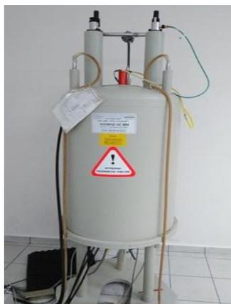
*Εικόνα 4.7: Φασματογράφος Bruker AV-250, όπου έγιναν οι μετρήσεις των δειγμάτων με φασματοσκοπία  $^1\text{H-NMR}$ .*
