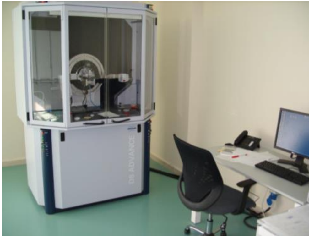
Σχήμα 6.6: Περιθλασίμετρο ακτίνων X Τμήματος Επιστήμης Υλικών Πανεπιστημίου Ιωαννίνων.
