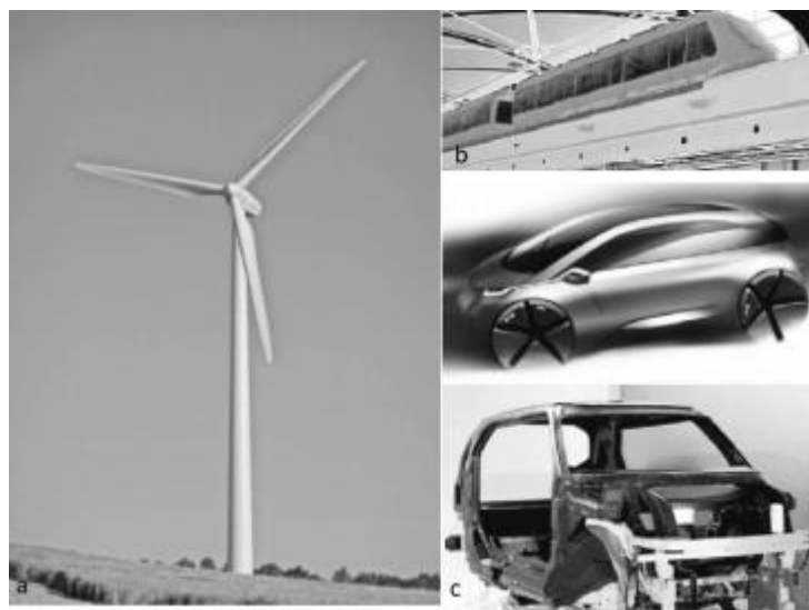
Εικόνα 1.1:Σύνθετα στην βιομηχανία σήμερα:(a) Σύνθετα πτερύγια ανεμογεννητριών, (b) Οχήματα μεταφοράς με αμάξωμα από σύνθετο υλικό ( TPI Σύνθετα), (c) Σκίτσο πρωτότυπου, cockpit από σύνθετα ανθρακονήματα και χωροδικτύωμα αλουμινίου BMW Megacity[2]
