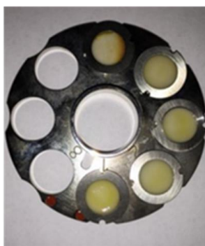
Εικόνα II.3.2. Αριστερά: Πολυκρυσταλλικό δείγμα του συμπλόκου ανθρώπινης ινσουλίνης – 4-βρωμορεσορσινόλης εναποτεθειμένο στο δειγματοφόρέα. Δεξιά: Ο θάλαμος υγρασίας MHC-trans-Anton Paar humidity chamber εγκατεστημένος στο εργαστηριακό περιθλασίμετρο X' pert Pro της εταιρείας Malvern Panalytical . Κέντρο: Ο ρότορας υποδοχής ( https://www.researchgate.net/publication/305986686_The_Power_of_Powder_Humidity_induced_phase_transitions_of_HEWL_ysozyme ).
