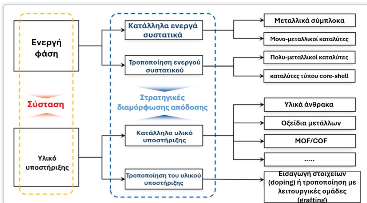
Εικόνα 25: Στρατηγικές διαμόρφωσης της απόδοσης υποστηριζόμενων ετερογενών καταλυτών για αφυδρογόνωση του FA 102 .
