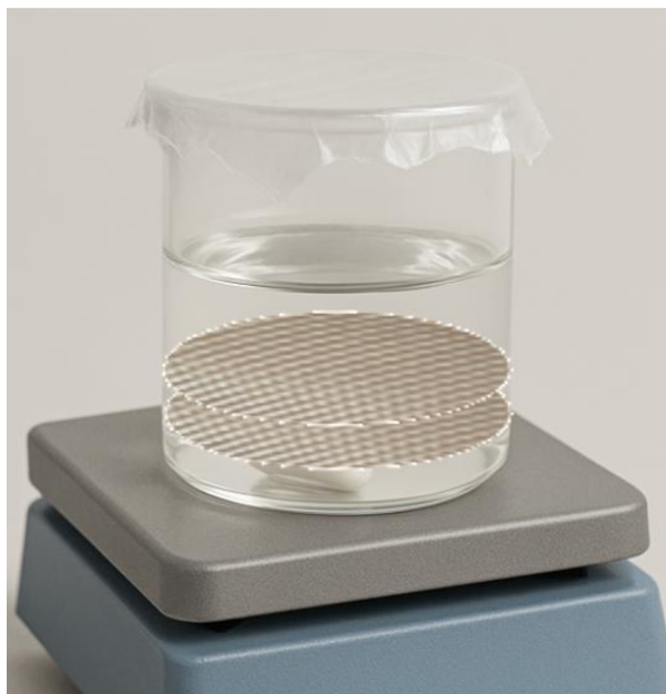
Εικόνα 66: Απεικόνιση της διάταξης επεξεργασίας του FA από το υλικό S.C[Ludox LS]@APTES.
