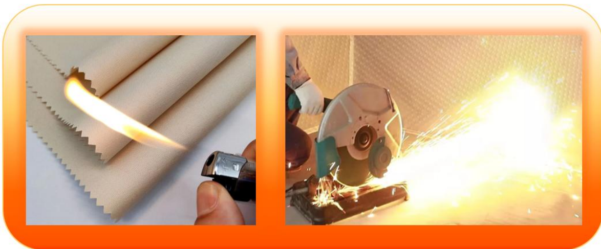
Εικόνα 60: Τα πυριτικά υφάσματα είναι υλικά με ανθεκτικότητα σε θερμοκρασίες που μπορούν να φτάσουν και τους 1400°C στην περίπτωση των άμορφων πυριτικών υφασμάτων 212 .
