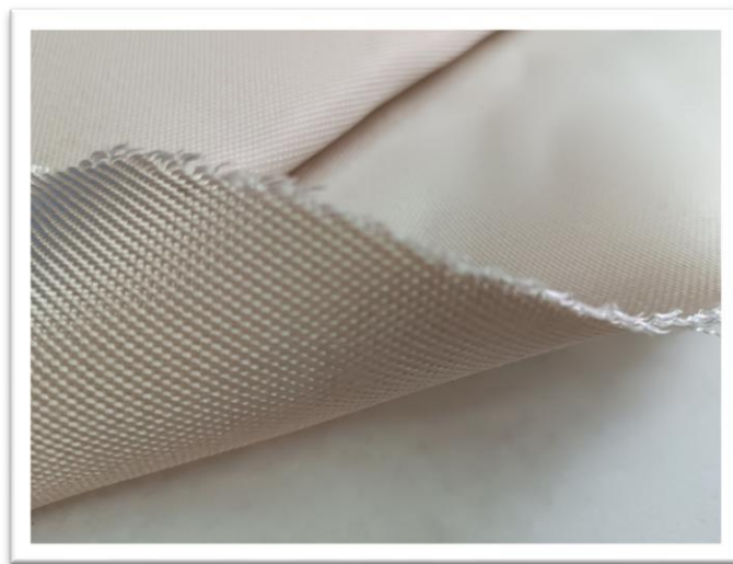
Εικόνα 63: Απεικόνιση του υφάσματος πυριτίας (S.C), όπως αυτό προμηθεύτηκε.
