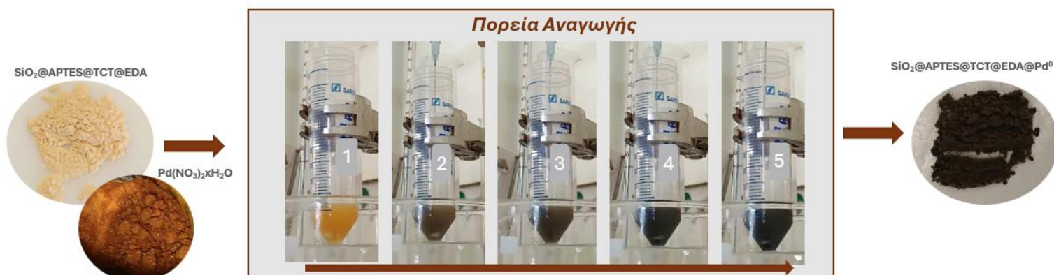
Εικόνα 55: Απεικόνιση της αναγωγής των ιόντων \text{Pd}^{+2} σε \text{Pd}^0 στην επιφάνεια του υλικού \text{SiO}_2@\text{APTES}@\text{TCT}@\text{EDA} με την προσθήκη \text{NaBH}_4
