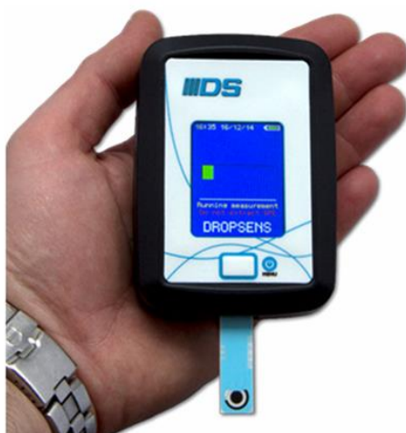
Σχήμα 6. Φορητός ποτενσιοστάτης με υποδοχή για τον εκτυπωμένο αισθητήρα [6].
