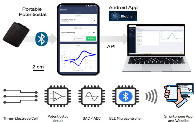
Σχήμα 7. Απεικόνιση της βασικής αρχιτεκτονικής ενός φορητού ποτενσιοστάτη, ο οποίος συνδέεται μέσω Bluetooth με συσκευή tablet ή smartphone για την άμεση καταγραφή των αποτελεσμάτων της ανάλυσης [10].
