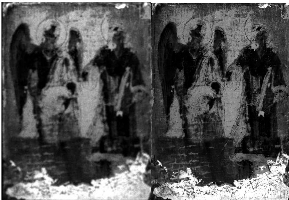
Εικόνα 112: Σύγκριση του στοιχειακού χάρτη για το Ασβέστιο (Ca-Kα) μεταξύ της ανάλυσης χαμηλής (αριστερά) και υψηλής (δεξιά) ανάλυσης. Η υψηλότερη ανάλυση αποκαλύπτει με μεγαλύτερη λεπτομέρεια τις φθορές και τη δομή του υποστρώματος.
