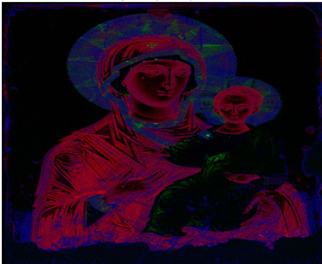
Εικόνα 167: Σύνθετος χάρτης στοιχειακής κατανομής (RGB Overlay) της εικόνας, που αποκαλύπτει τη στρωματογραφία των υλικών. Αντιστοίχιση χρωμάτων: Κόκκινο (R) = Σίδηρος (Fe-Ka1), Πράσινο (G) = Χρυσός (Au-La1), Μπλε (B) = Ασβέστιο (Ca-Ka1). Η επικάλυψη του σήματος του σιδήρου (κόκκινο) και του χρυσού (πράσινο) στα φωτοστέφανα επιβεβαιώνει τη χρήση μπόλου ως υπόστρωμα για τη χρύσωση.
