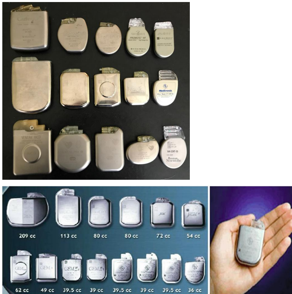
Εικόνα 2. Εξέλιξη του μεγέθους της γεννήτριας των εμφυτεύσιμων απινιδιστών. Σε κάθε σειρά φαίνονται μοντέλα διαφόρων εταιρειών και η εξέλιξη από τα παλαιότερα (αριστερά) ως τα νεότερα (δεξιά).
