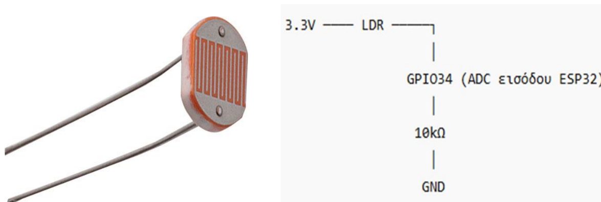
Εικόνα 2.5 Ο αισθητήρας έντασης φωτός LDR και το διάγραμμα σύνδεσης με το σύστημα ESP32
