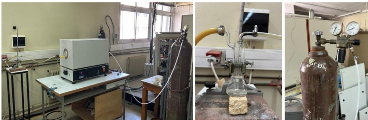
Σχήμα 2.3 Πειραματική διάταξη σύνθεσης στερεάς κατάστασης υπό ροή αερίου (Ar). Η διάταξη αποτελείται από αντλία αερίου Αργού, φούρνο θερμικής επεξεργασίας και σύστημα ελέγχου ροής αερίου.
