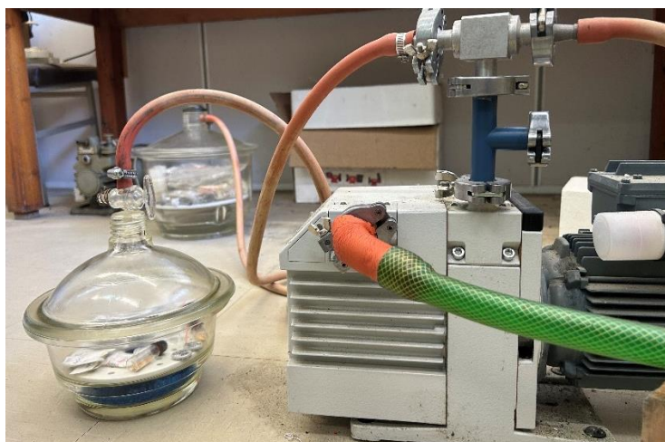
Σχήμα 1.3 Μηχανική αντλία και θάλαμοι κενού αποθήκευσης δειγμάτων, με σκοπό την αποφυγή επίδρασης περιβαλλοντικών παραγόντων.
