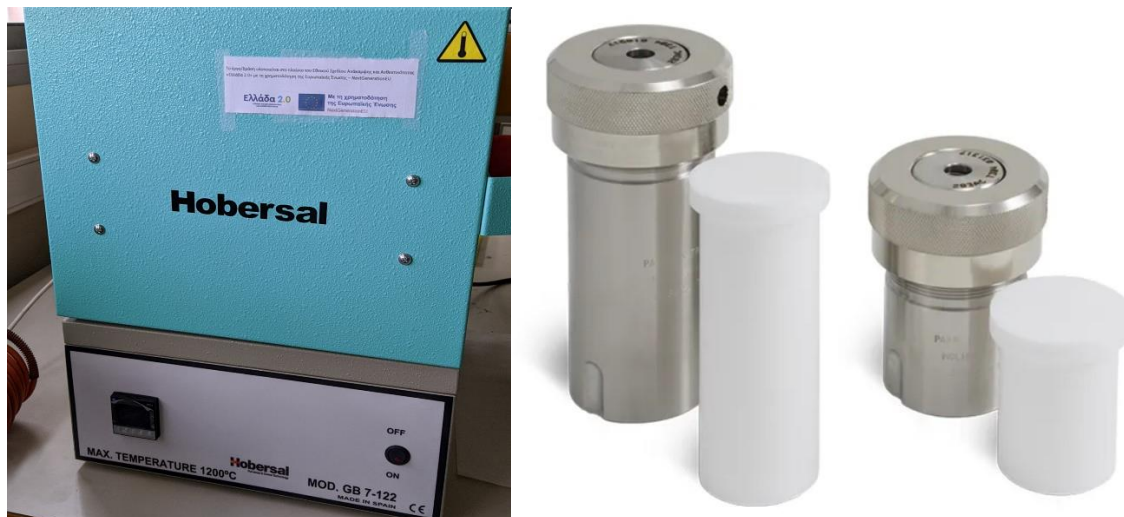
Σχήμα 2.1 Βασικά μέρη υδροθερμικής σύνθεσης δειγμάτων. Φούρνος θερμικής επεξεργασίας της εταιρείας Hobersal (αριστερά). Αυτοκλείστα (autoclave) δοχεία αποθήκευσης δειγμάτων κατά την διαδικασία ανόπτησης υπό υψηλές πιέσεις (δεξιά) [ https://www.parrinst.com/products/sample-preparation/acid-digestion/applications/hydrothermal-synthesis/ ]
