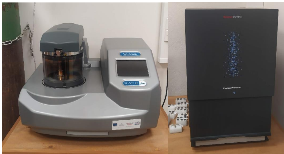
Σχήμα 3.4.2 Μονάδα sputtering δειγμάτων με Cr (αριστερά). Γενική άποψη Ηλεκτρονικού Μικροσκοπίου Σάρωσης SEM (δεξιά).
