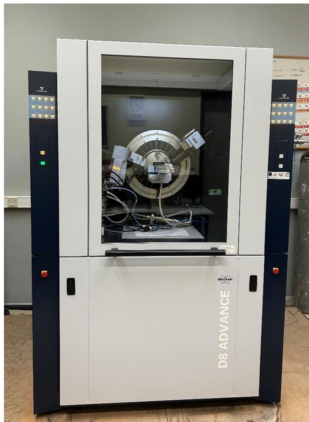
Σχήμα 3.1.1 Γενική άποψη του συστήματος Περίθλασης Ακτινών – X, Εργαστηρίου Φυσικής Υλικών του Τμήματος Φυσικής του Πανεπιστημίου Ιωαννίνων.
