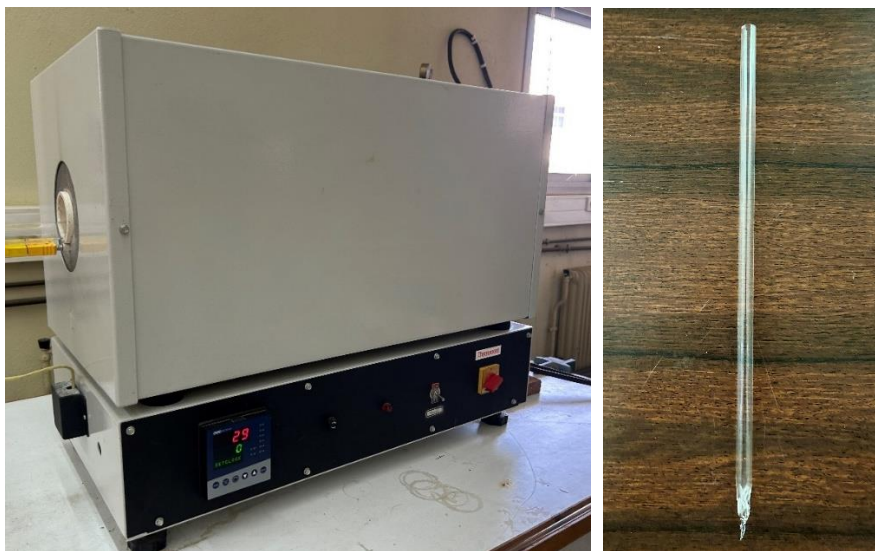
Σχήμα 2.2 Πειραματική διάταξη σύνθεσης στερεάς κατάστασης. Απεικονίζονται ο φούρνος θερμικής επεξεργασίας και η αμπούλα (tube) χαλαζία.
